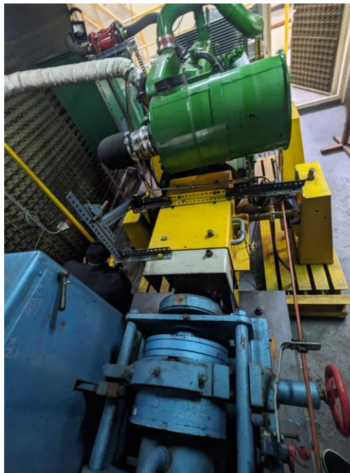
Imagen 4-1: Cimientos, bancada y transmisión motor Mercedes Benz OM-366 LA. Laboratorio Termofluidos UTFSM.
