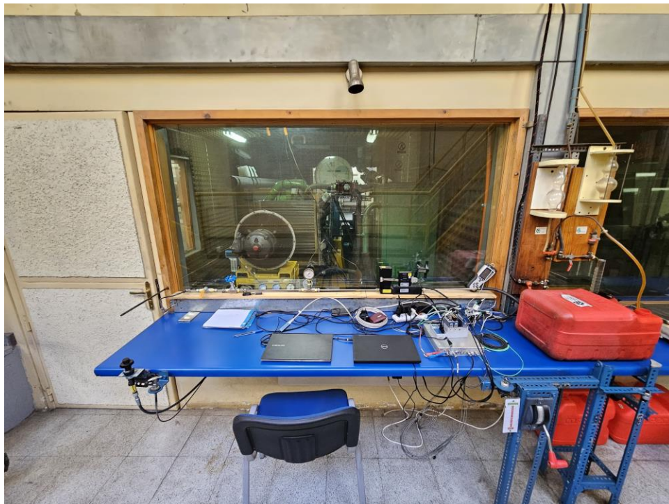
Imagen 4-3: Rack de control del motor Mercedes Benz OM-366LA.
