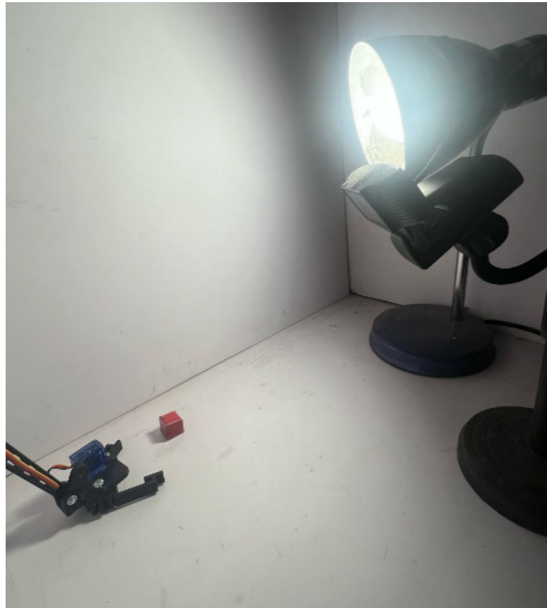
Figura 5.1: Montaje físico del sistema de prueba. Se observa el gripper robótico montado frente al objeto, así como la cámara RGB encargada de capturar las imágenes de entrada al sistema.
