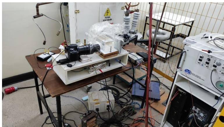
Figura 3 Banco de ensayo en alta tensión arboles eléctricos (Fuente: propia)
