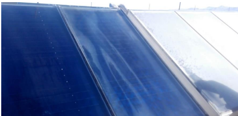
Figura 28: Resultado método con agua fría a presión y secado con plumilla
