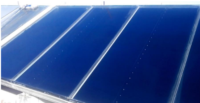
Figura 29: Resultado método con elemento abrasivo, agua fría y secado con plumilla
