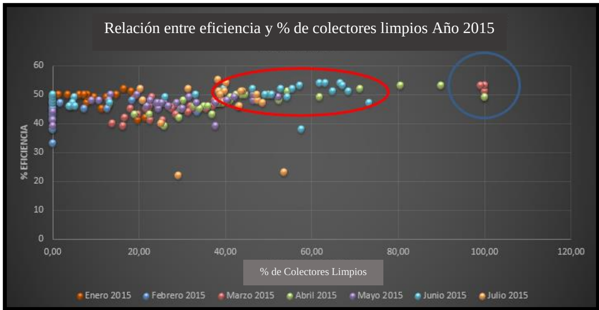
Figura 11: Grafico Dispersión - Eficiencia vs % de colectores Limpios.
