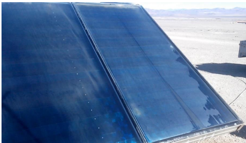
Figura 26: Resultado método con vapor de agua a presión y secado con plumilla
