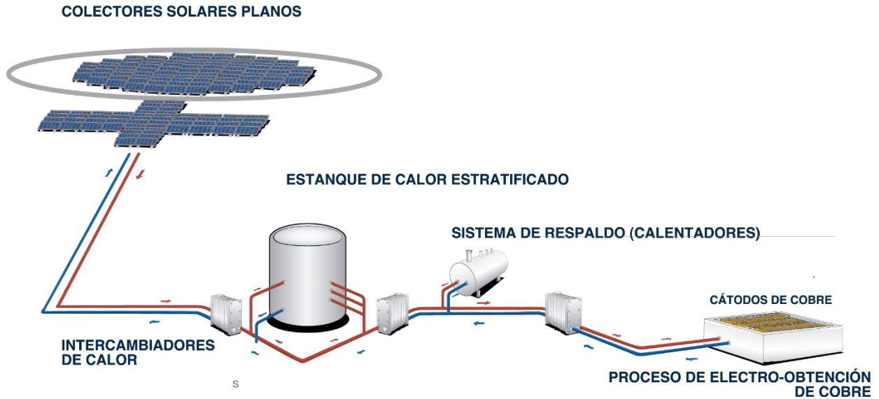
Figura 2: Esquema de Planta Solar "PES" [2]
