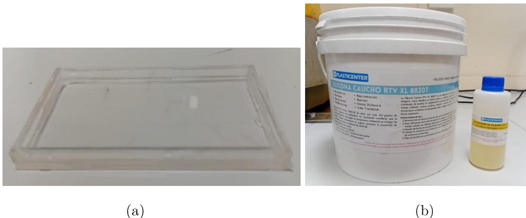
Figura 20: (a) Molde para la fase de silicona. (b) Silicona caucho TRV XL 8820T con catalizador.
