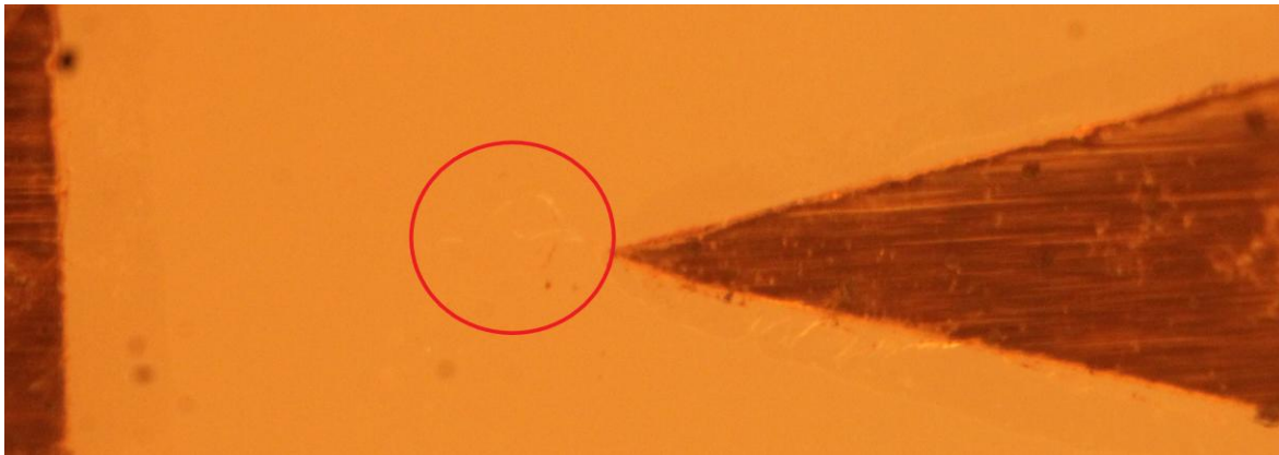
Figura 81: Interfaz de la probeta AC_B_3 con arborización eléctrica.
