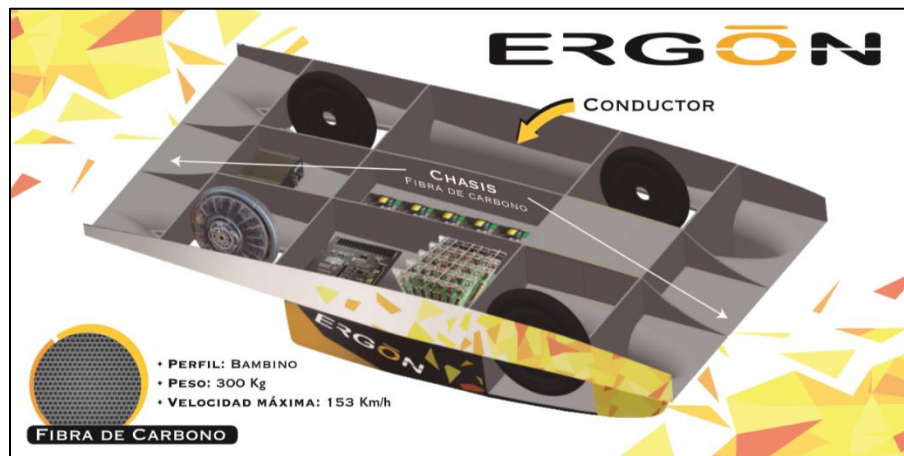
Figura 2.2.5. Esquema de la distribución interior de los principales componentes del auto solar Ergón.
