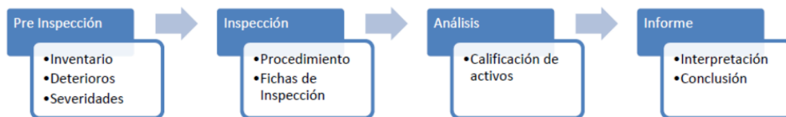
Ilustración 32. Proceso general de inspección de activos. (Arriagada y Echaveguren; Manual de Inspección Visual de Activos de Saneamiento y Drenaje de Carreteras).
