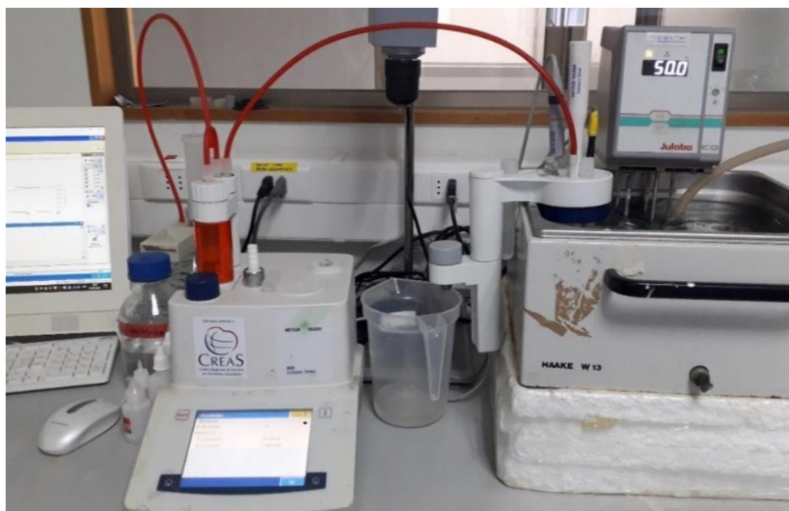
Figura 16. Fotografía instalación experimental para el ensayo de actividad con esquelón de salmón.
