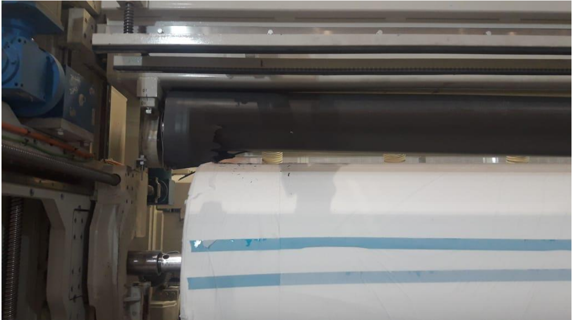
Figura 3-6: Imagen destrucción rodillo prensa
