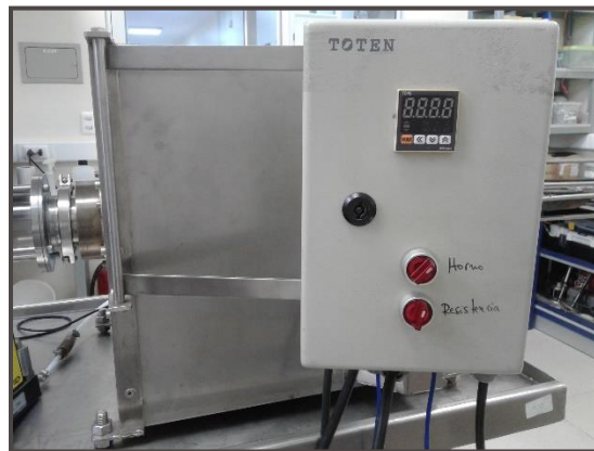
Figura 5.22 Panel de control temperatura horno. Fuente: Elaboración propia.
