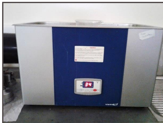
Figura 5.57 Baño de ultrasonido VWR 97043-978.
