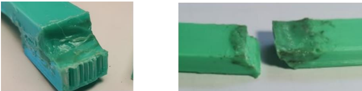
Ilustración 50 Calidad superficial y terminaciones en probetas bajo método Cautín con boquilla.
