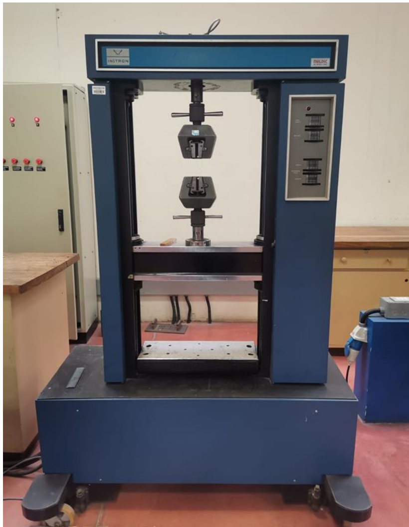
Ilustración 14 Equipo para ensayos de tracción Instron TTCN - 10
