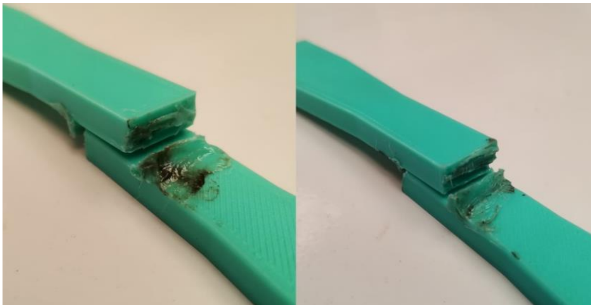
Ilustración 32 Fractura probeta PCI - Unión en traslape con E.C.
