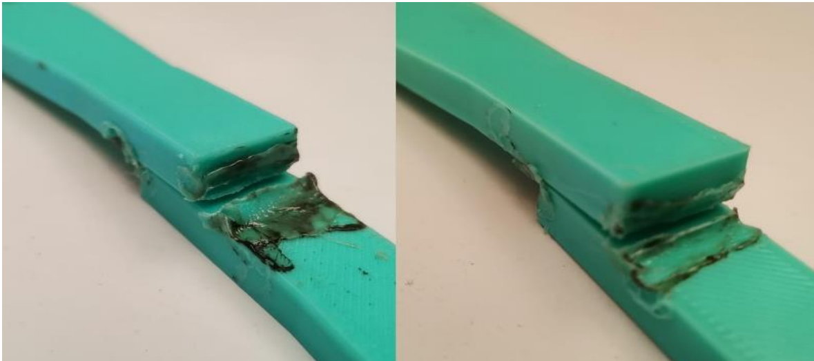
Ilustración 33 Fractura probeta PC2 - Unión en traslape con E.C.
