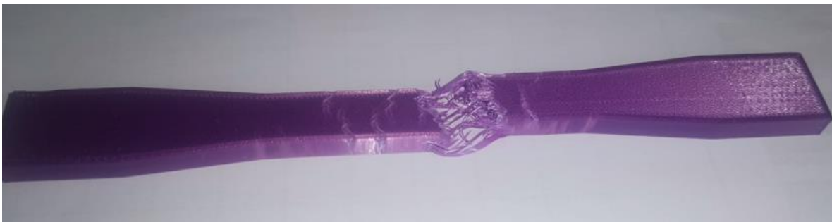
Ilustración 55 Resultado del ensayo de tracción - Probeta de prueba
