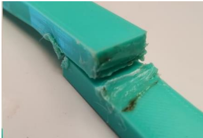
Ilustración 53 Falla adhesiva en la interfaz en probeta C12 - Unión en traslape con E.C.
