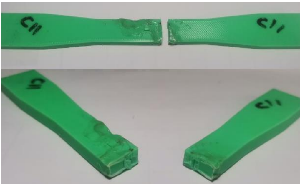
Ilustración 45 Fractura probeta C11 - Unión en traslape
