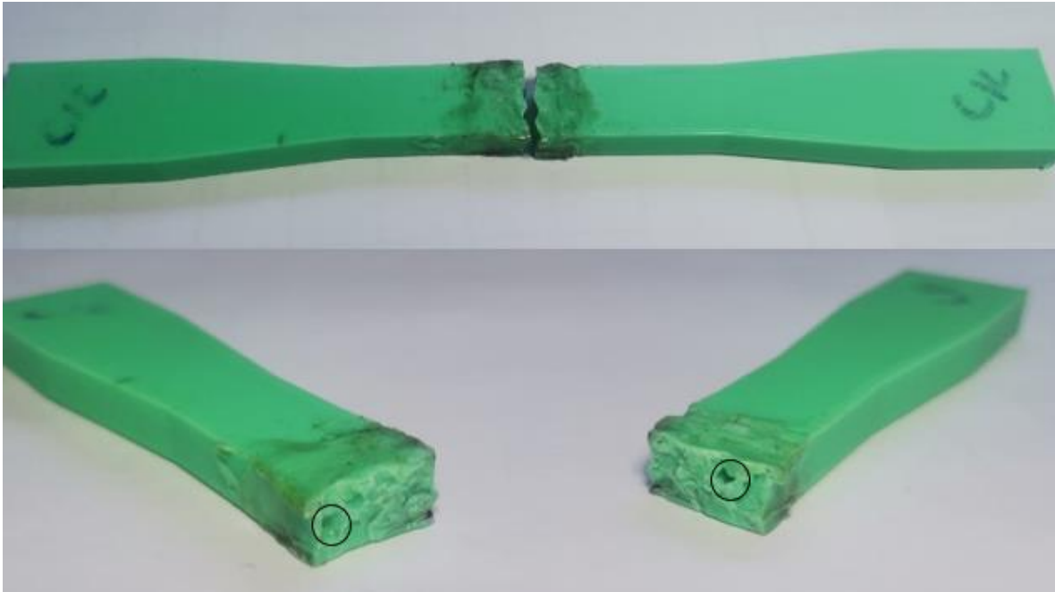
Ilustración 24 Fractura probeta C12 - Unión en V
