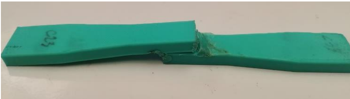
Ilustración 40 Fractura probeta C23 - Unión en traslape con E.C.
