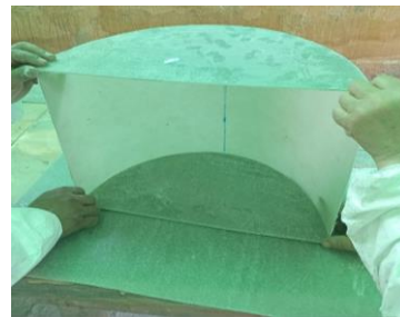
Imagen 52. Fibra con resina endurecida con medidas del Embolsador
