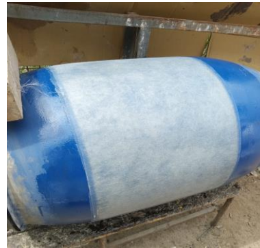
Imagen 51. Capas de fibra de vidrio tomando curvatura en tarro
