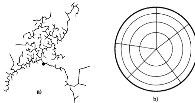
Figura 2.1: (a) División de nodos tipo árbol. (b) Separación de nodos considerando regiones polares
