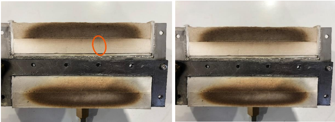
Figura A.44: Vista lateral del quemador abierto destacado y “en limpio”.
