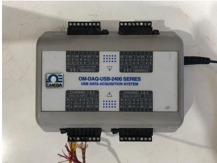
Figura 3.24: Módulo de adquisición de datos o Data logger, empleado para medición de temperaturas.
