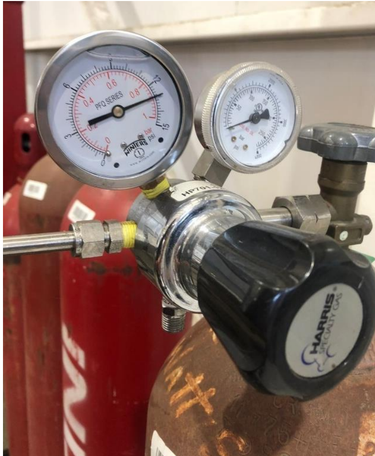
Figura 3.10: Regulador de presión para hidrógeno y manómetros correspondientes
