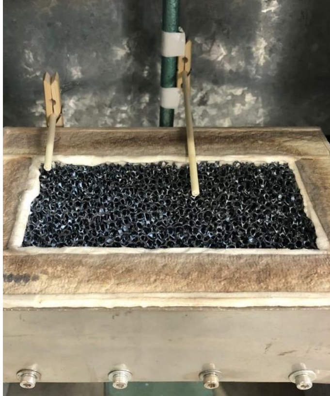
Figura 3.22: Termopar tipo S instaladas sobre MPI.
