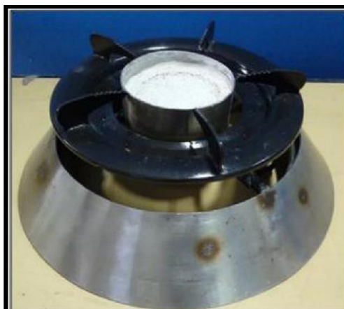
Figura 2.4: Quemador estabilizado en superficie desarrollado por Mujeebu [15].
