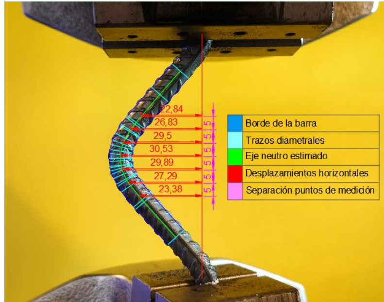
Figura 25. Mediciones de los desplazamientos horizontales realizados en AutoCAD de la barra AZA pandeada durante el ensayo BBT con \beta = 19.4\% de compresión (unidades en mm).
