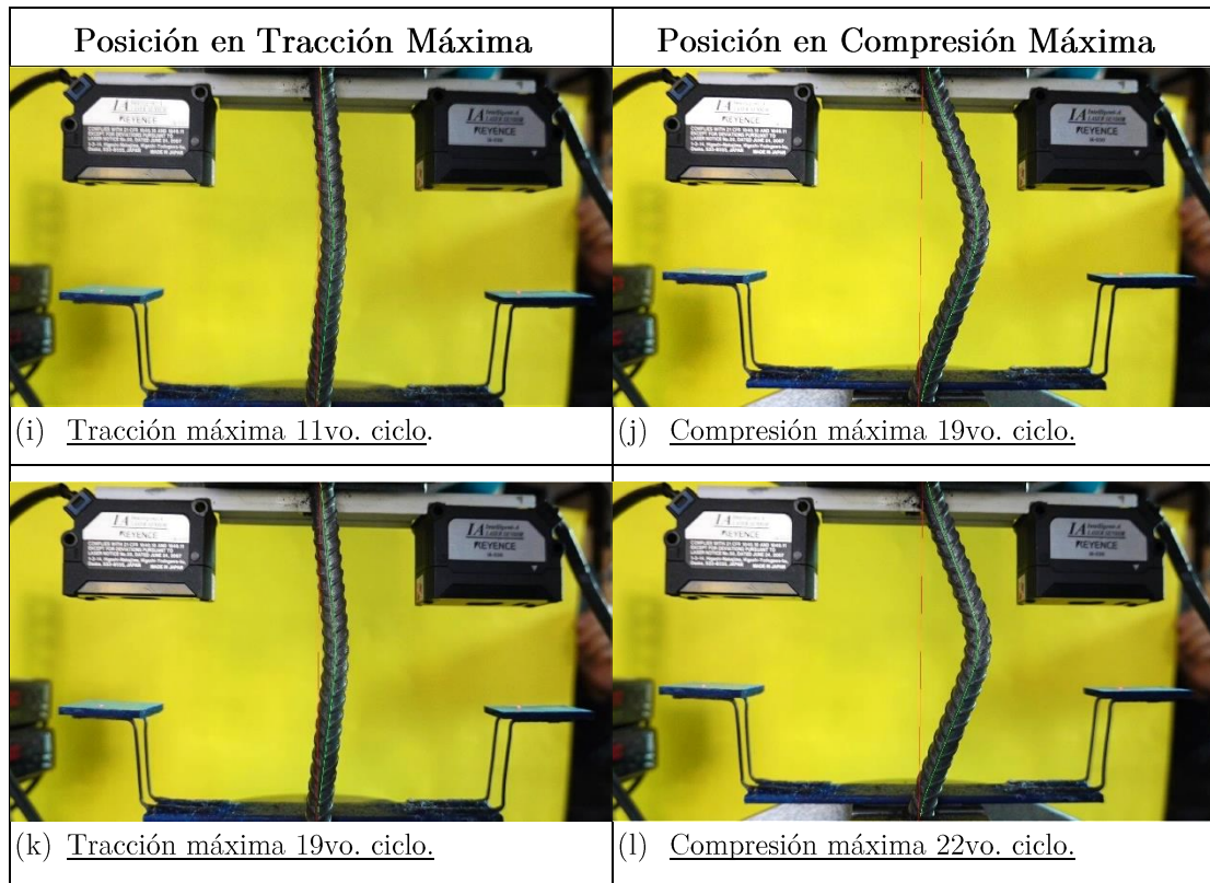
Figura 63. Posiciones extremas de la barra AZA ( L/D = 14 ) entre el 11vo. ciclo y el 22vo. ciclo del ensayo de fatiga ( \beta = 3\% ).
