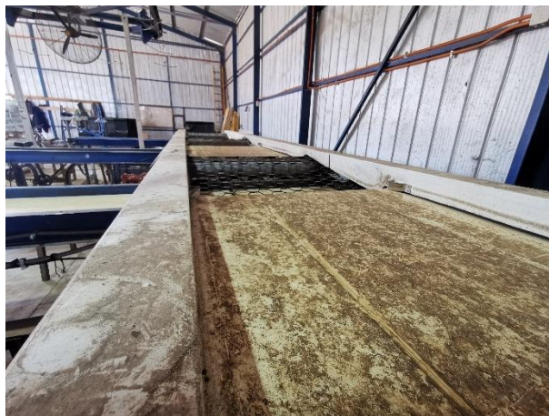
Foto 5: "Clasificación por Calibres mediante Mallas Calibradoras - confección propia "
