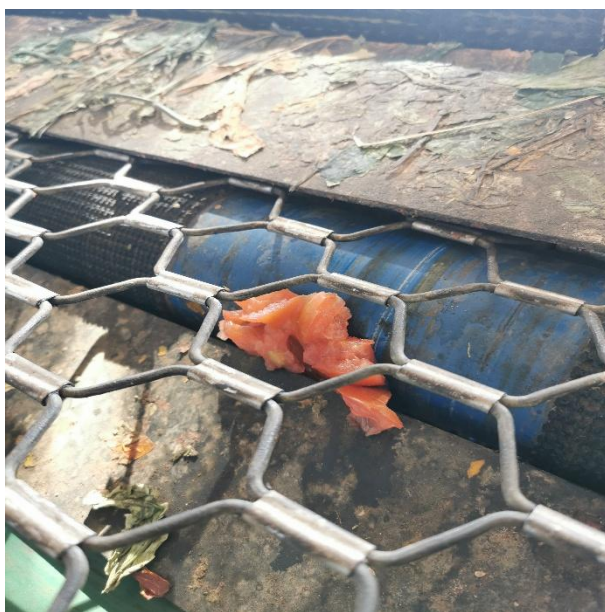
Foto 12: “Tomates aplastados sección Calibre 7 - confección propia”
