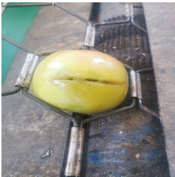
Foto 13: “Tomate cortado por malla calibradora - confección propia”
