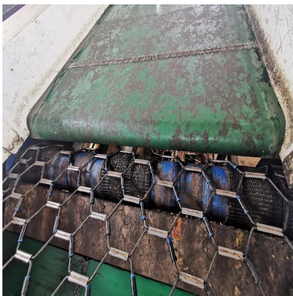
Foto 19: “Separación cinta transportadora y malla calibradora - confección propia”
