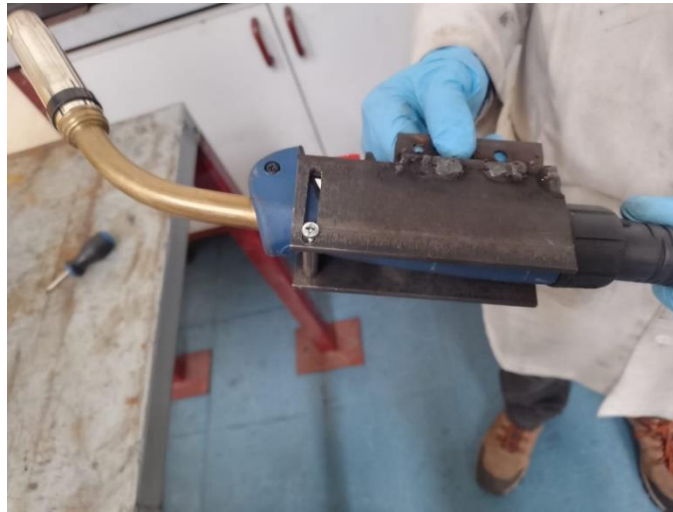
Figura 10 Accesorio "Holder" para sujeción de la torcha al robot KUKA
