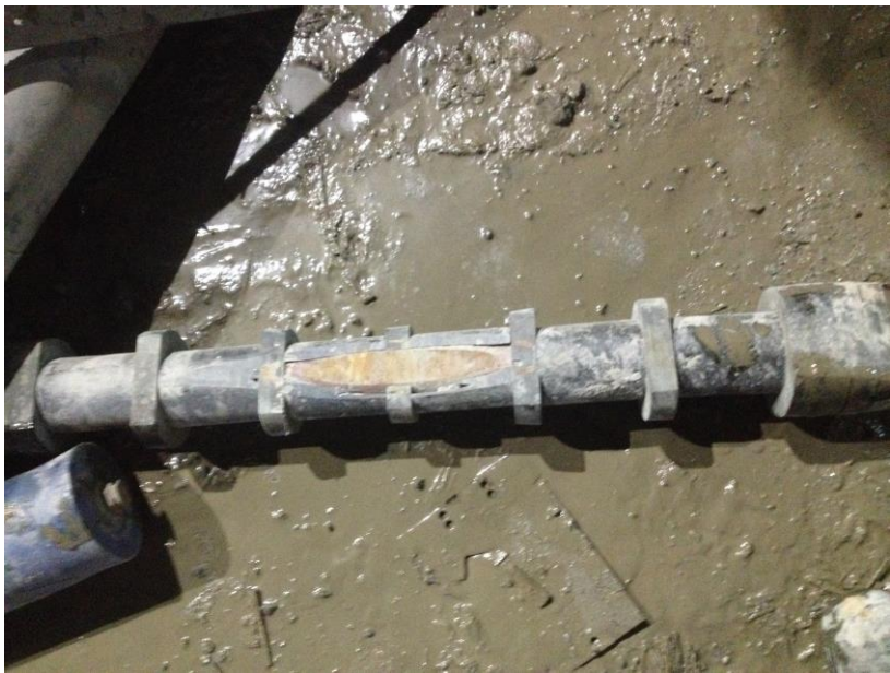
Fuente: Fotografía personal en chancado fino, polín de carga roto, Codelco división Andina
