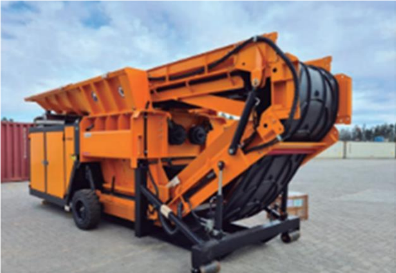
Figura 2-18 Cinta transportadora plegable
