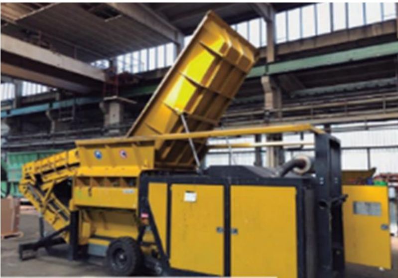
Figura 2-19 Sistema de inclinación tolva basculante
