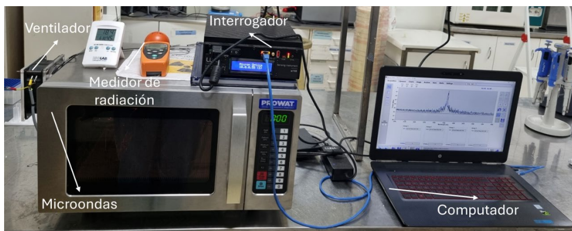
Figura 10. Sistema de secado hidroconectivo acoplado a microondas en laboratorio
