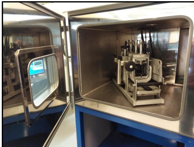
Figura 4-5: Cámara ambiental. Elaboración propia
