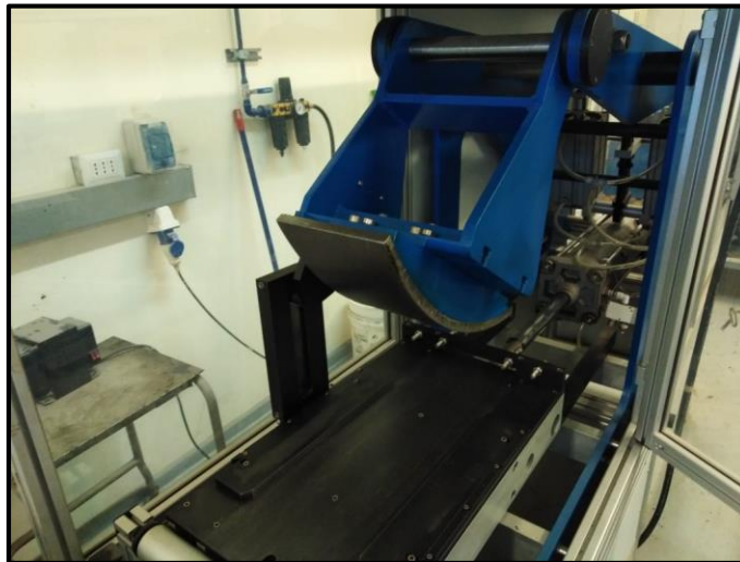
Figura 4-6: Compactador de rodillo. Elaboración propia.
