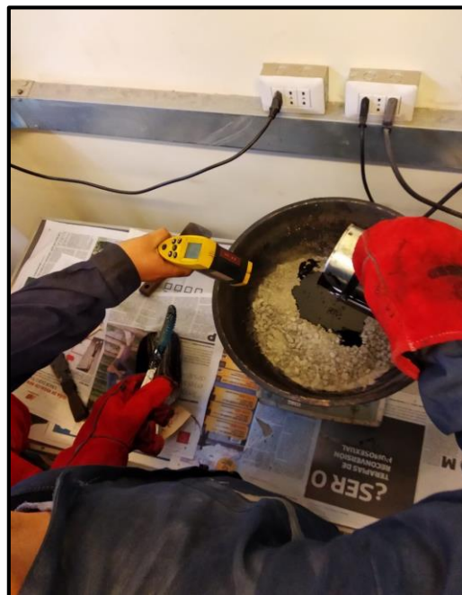
Figura 4-8: incorporación de ligante en áridos. Elaboración propia.
