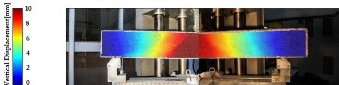
Figura 4.29: Fotogrametría en la imagen 25 durante el ensayo de carga en la viga 1.
