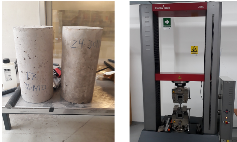
Figura 4.8: Probetas para realizar ensayos de compresión y tracción.
