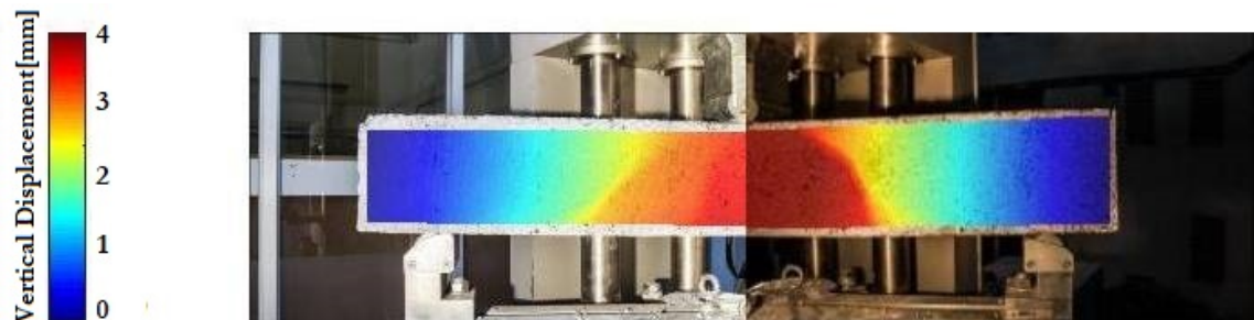
Figura 4.33: Fotogrametría en la imagen 19 durante el ensayo de carga en la viga 2.
