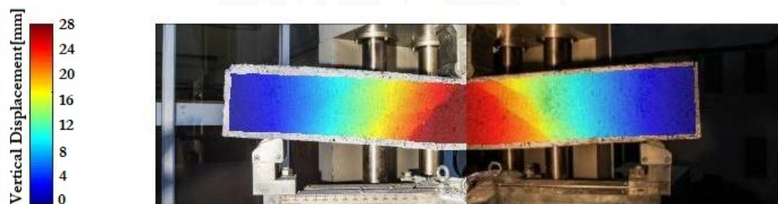
Figura 4.35: Fotogrametría en la imagen 29 durante el ensayo de carga en la viga 2.
