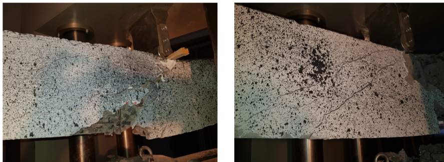
Figura 4.25: Viga 2 - Desarrollo de grietas en el elemento.
