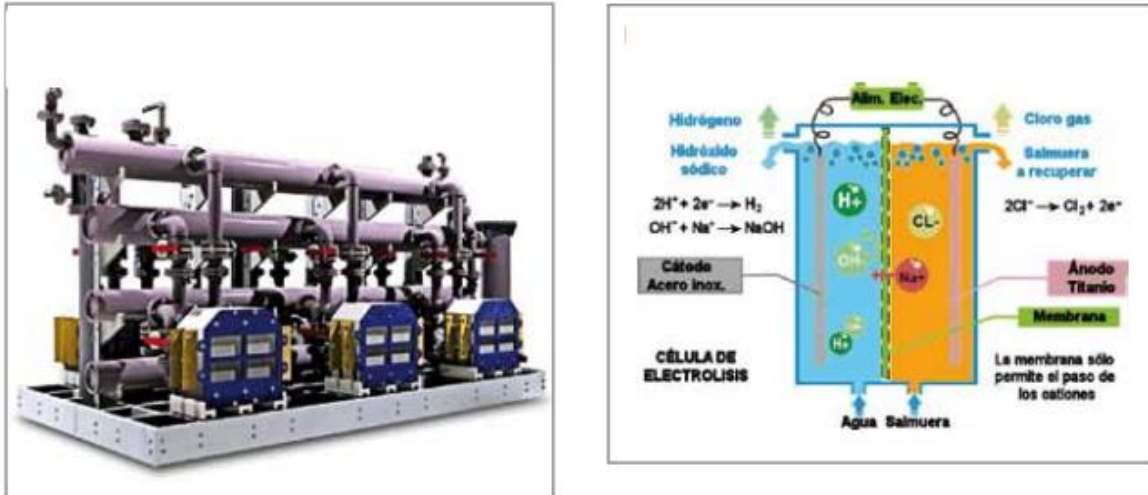
Figura 4.3: a) Generador de cloro por electrólisis con celda con membrana; b) Celda con membrana.
