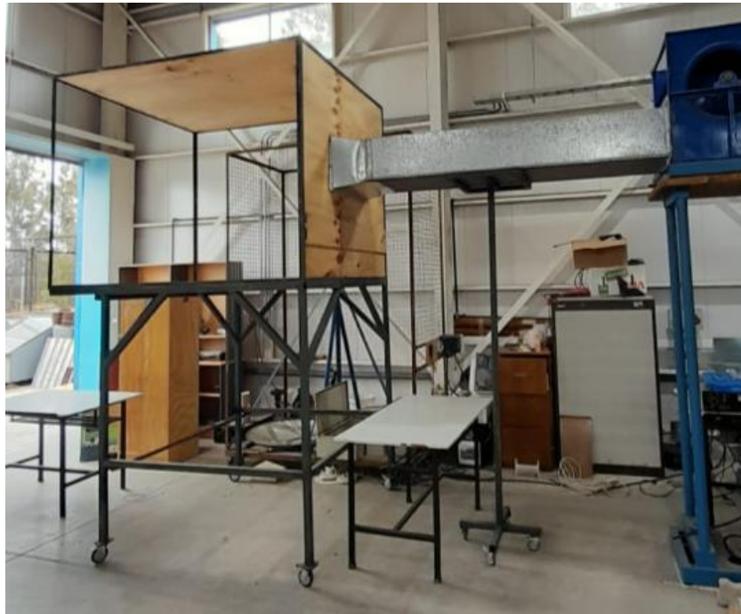
Figura 54, Vista lateral de túnel de viento construido antes de instalación de paredes de acrílico.
