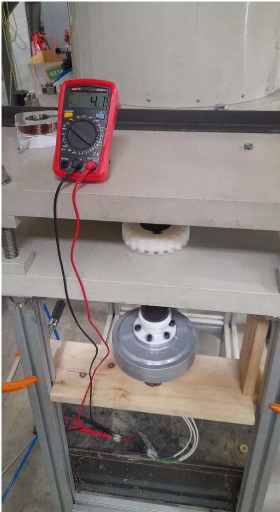
Figura 63, Configuración eléctrica para prueba de vacío.
