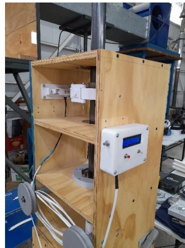
Figura 58, Acercamiento a conexión entre freno, dinamómetro y cajetín del arduino nano.
