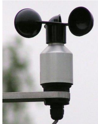
Figura 22, Anemómetro de copa o veleta [20].
