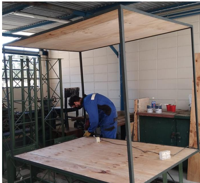
Figura 71, Registro fotográfico de trabajo de carpintería para manufactura de túnel de viento.
