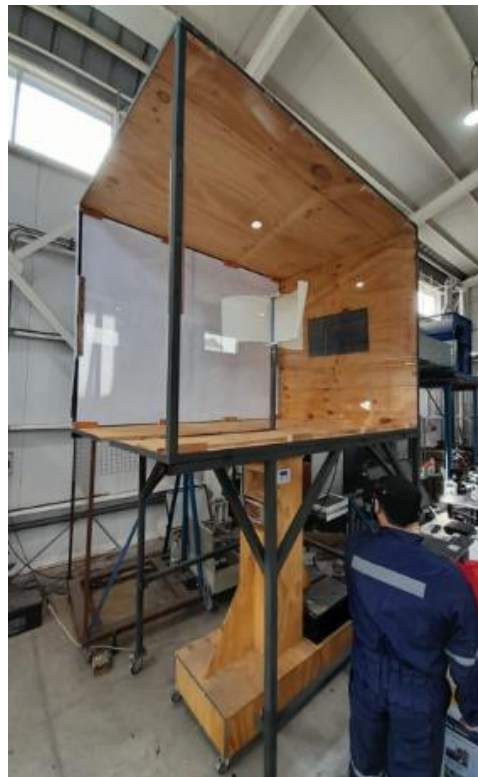
Figura 55, Vista posterior de túnel de viento terminado y listo para operar con turbina instalada sobre freno dinamométrico.
