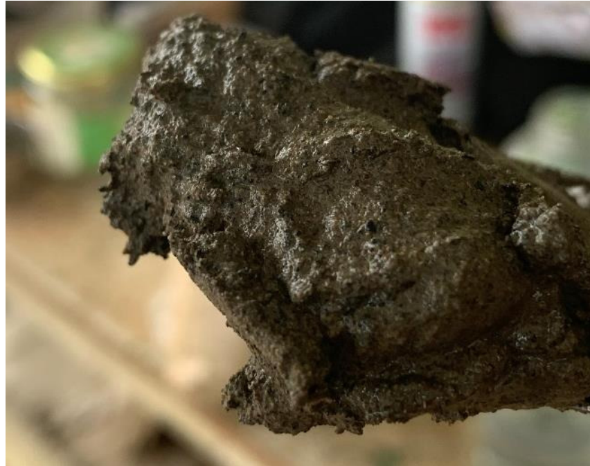
Fig. 31 - Mezcla adhesivo y polvo de caucho
