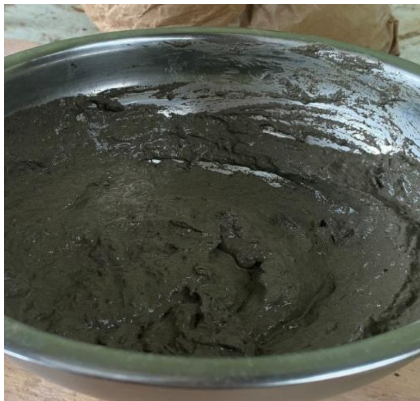
Fig. 29 Mezcla adhesivo, caucho triturado y polvo
