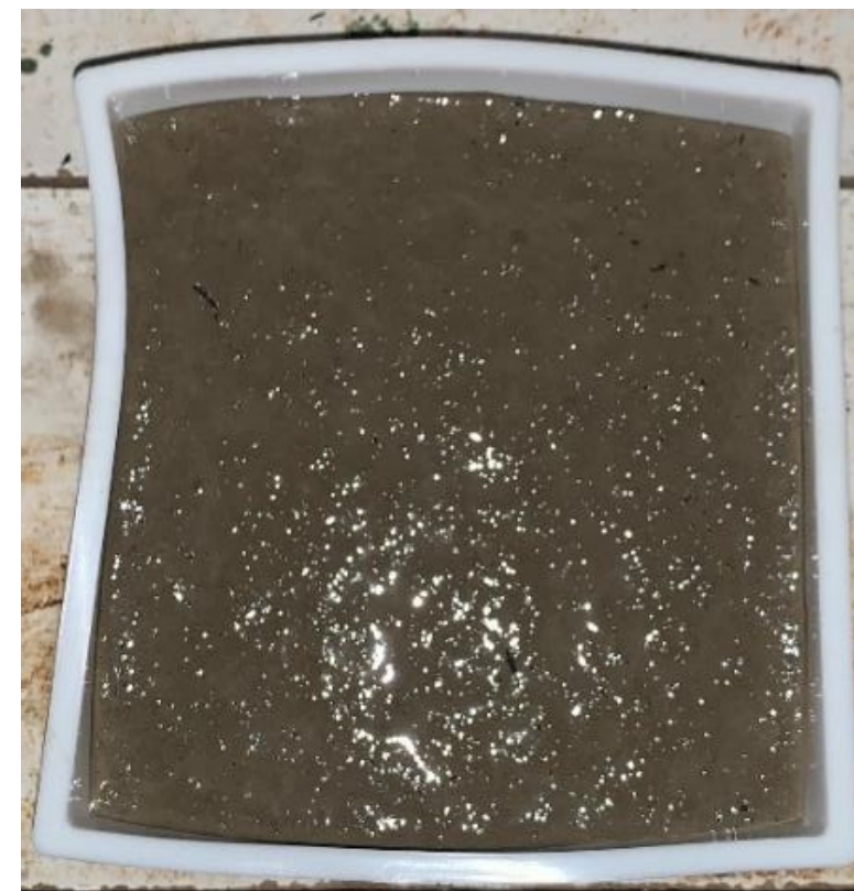
Fig. 38 – Mezcla en molde para MVP pastelones con fibras
