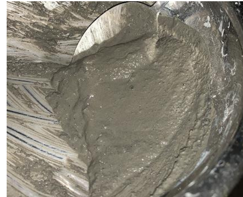
Fig. 45 - Mezcla con polvillo y cemento esculturas
