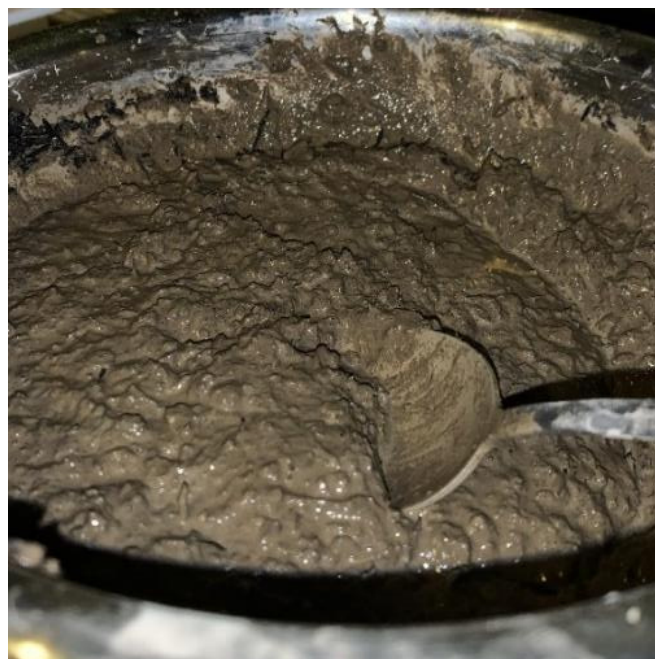
Fig. 37 – Mezcla MVP pastelones con fibras
