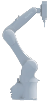
Ilustración 10. Montaje electro husillo en agilus KR6. Elaboración propia.
