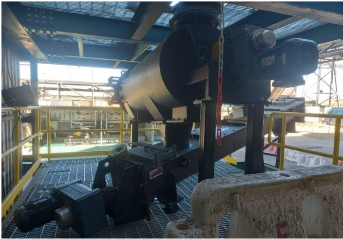
Figura 2- 14: Pantalla rotatoria y tornillo helicoidal.
