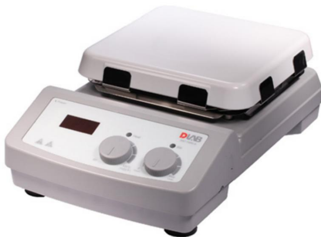
Figura 3.2: Agitador magnético JKI (JKDMS-PROII).
