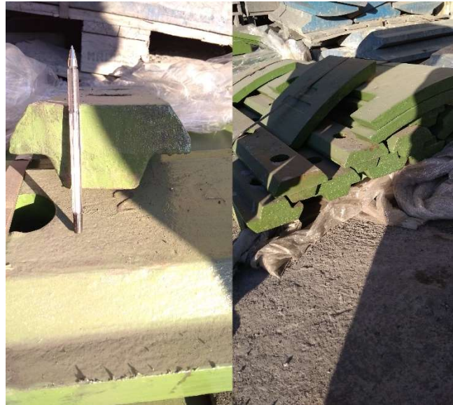
Figura 6. Revestimiento y levantador actuales del molino 6'x5'.
