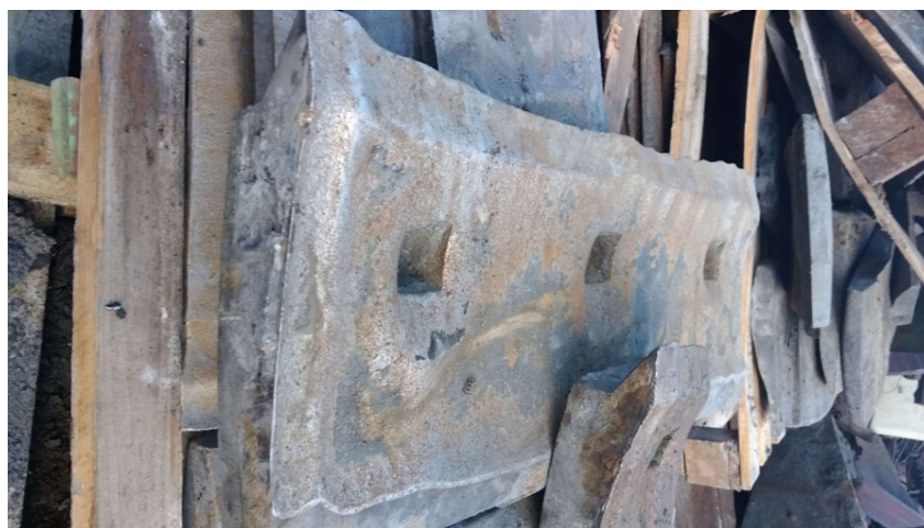
Figura 35. Revestimiento anterior del molino Allis Chalmers 5'x6'.
