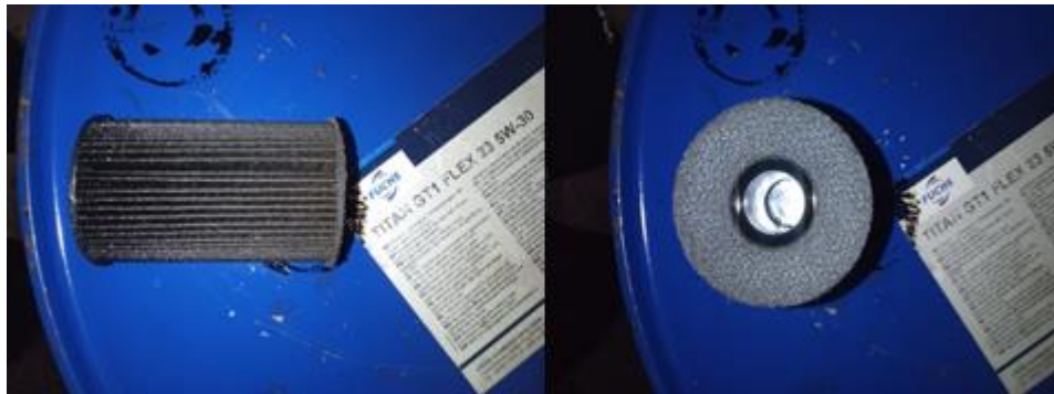
Figura 1-16: Filtro de aceite de elemento contaminado
