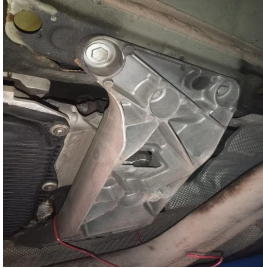
Figura 3- 3: soltar soporte para el tapón de llenado
