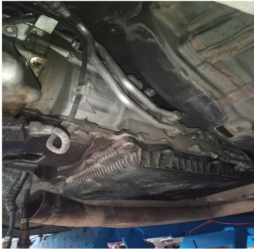
Figura 3- 1: caja de cambios en elevador
