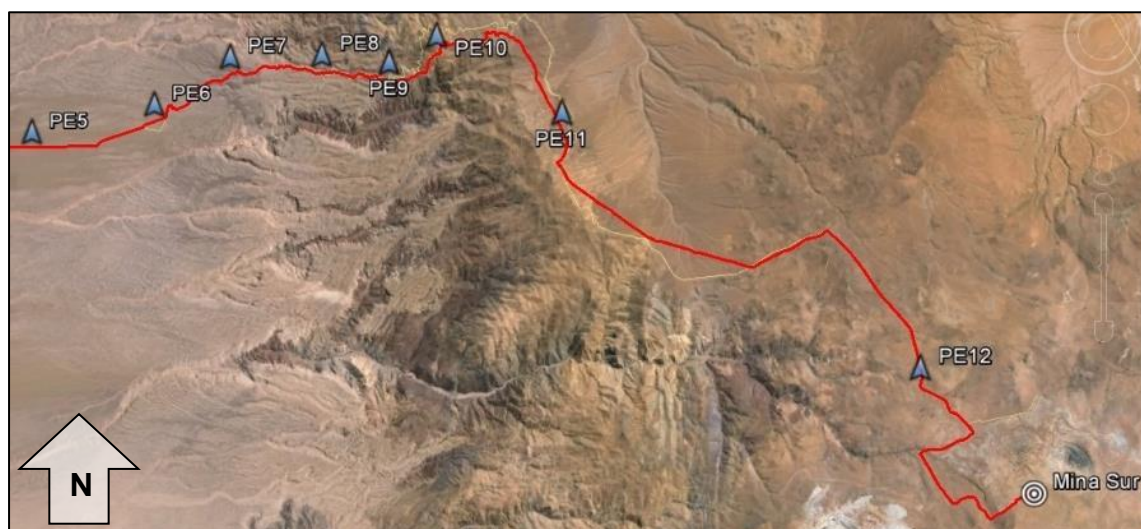
Figura 5.59. Ubicación Plantas Elevadoras 150 [l/s]. SWAP Sur (Carmelo – Mina Tramo 2). Fuente: Elaboración Propia en Google Earth.
