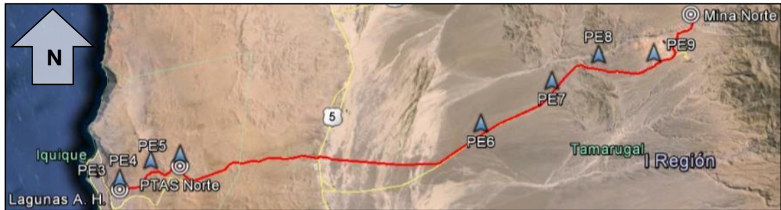
Figura 5.39. Ubicación Plantas Elevadoras 750 [l/s]. Aguas Servidas Norte. Fuente: Elaboración Propia en Google Earth.
