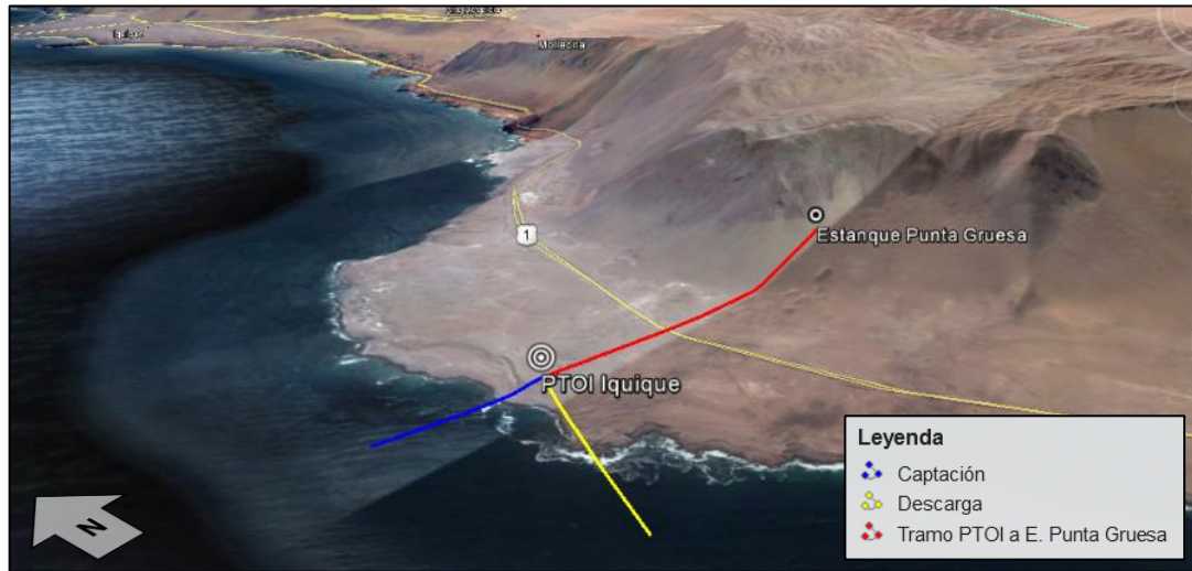
Figura 5.56. Trazado SWAP PTOI – Estanque P. Gruesa. Fuente: Elaboración Propia en Google Earth.
