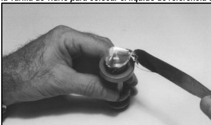
**Fig. 6. Uso de la espátula para colocar el líquido de referencia.**
