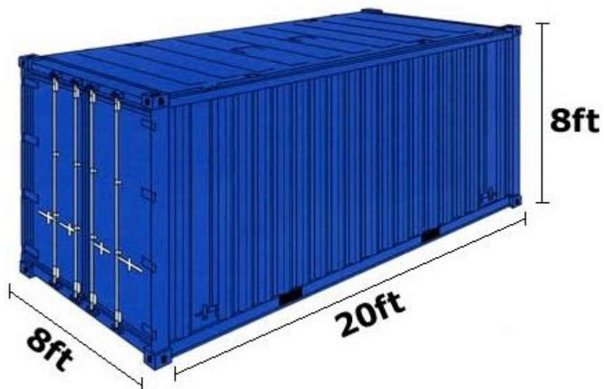
Figura 1-6 Dimensiones exteriores de un contenedor normalizado.
