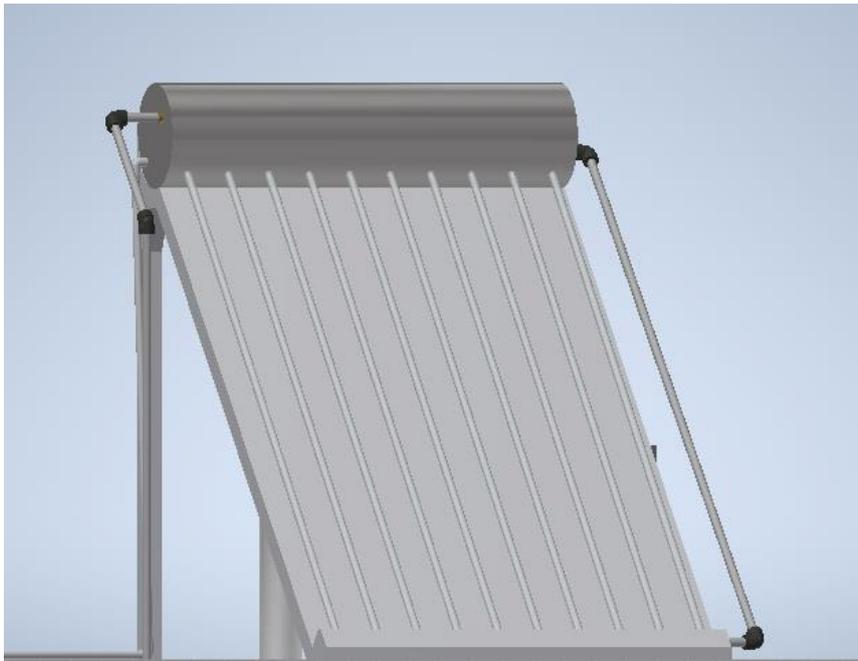
Figura 52: Representación de colector solar en el sistema de calefacción en Autodesk Inventor 2020. Fuente: Elaboración Propia
