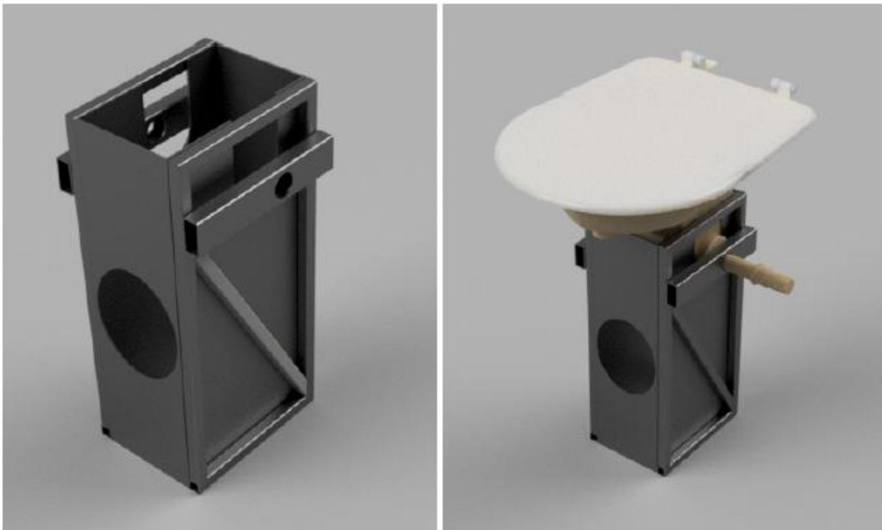
Figura 46: Ducto de descarga con estructura de soporte diseñado en Autodesk Inventor.
