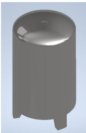
Figura 68: Representación de estanque acumulador de biogás en Autodesk Inventor 2020.
