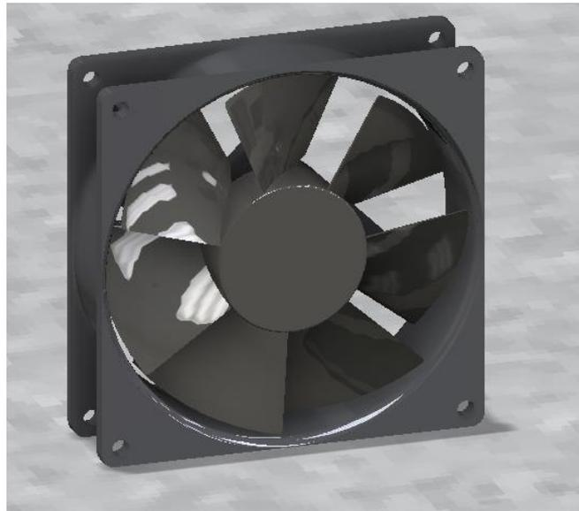
Figura 63: Representación extractor de olores subsistema de ventilación en Autodesk Inventor 2020. Fuente: Elaboración Propia.
