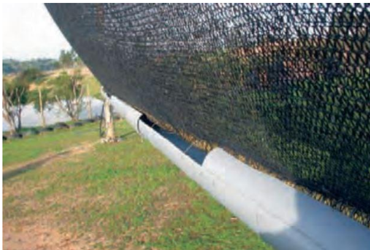
Figura 5: Sistema de captación de agua a través de la niebla.
