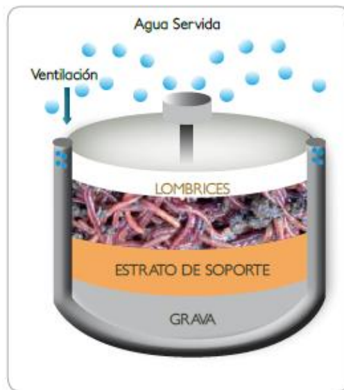
Figura 8. Esquema general de un Lombrifiltro.
