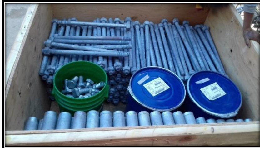
Figura 2-11 Pernos utilizados en la instalación de los aisladores sísmicos.
