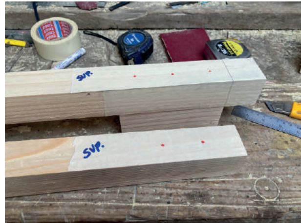
Figura 280 - 283: Tercera etapa - Trazado y perforaciones. Elaboración propia.
