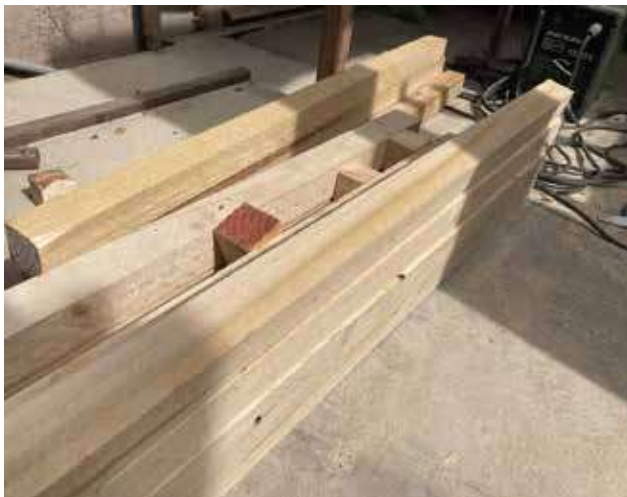
Figura 135: Estructura pilares compuestos - prueba prototipo N°2. Elaboración propia.
