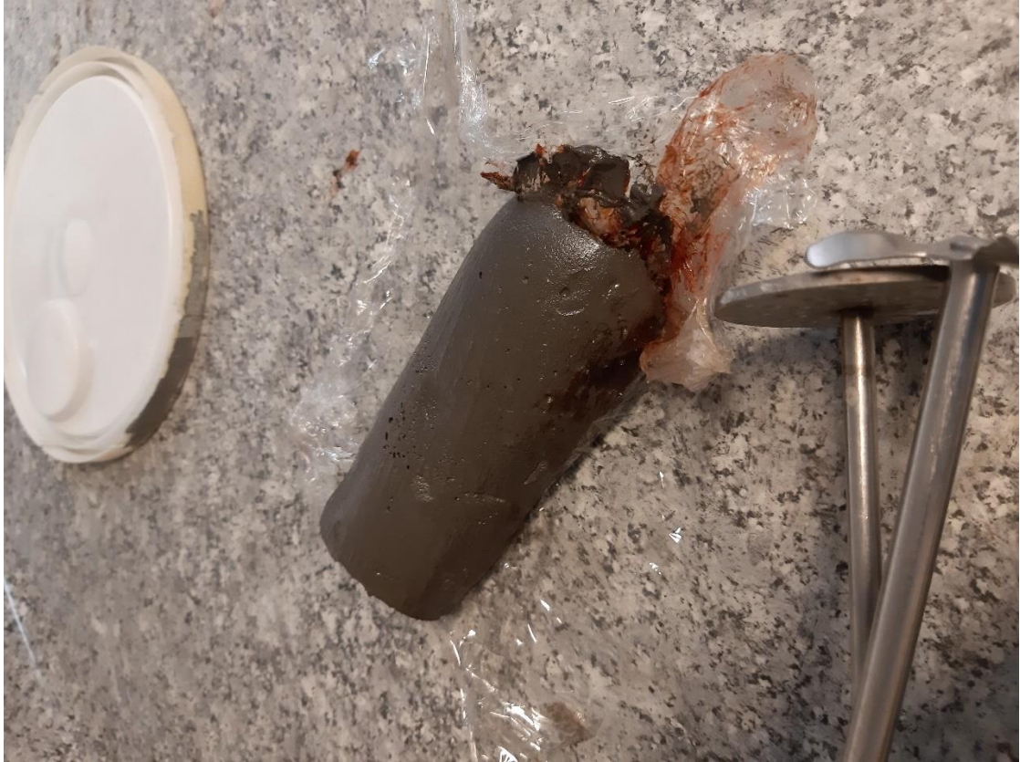
Ilustración 46 Desmolde pasado un minuto método 6 razón A-S 20% 1ra réplica
