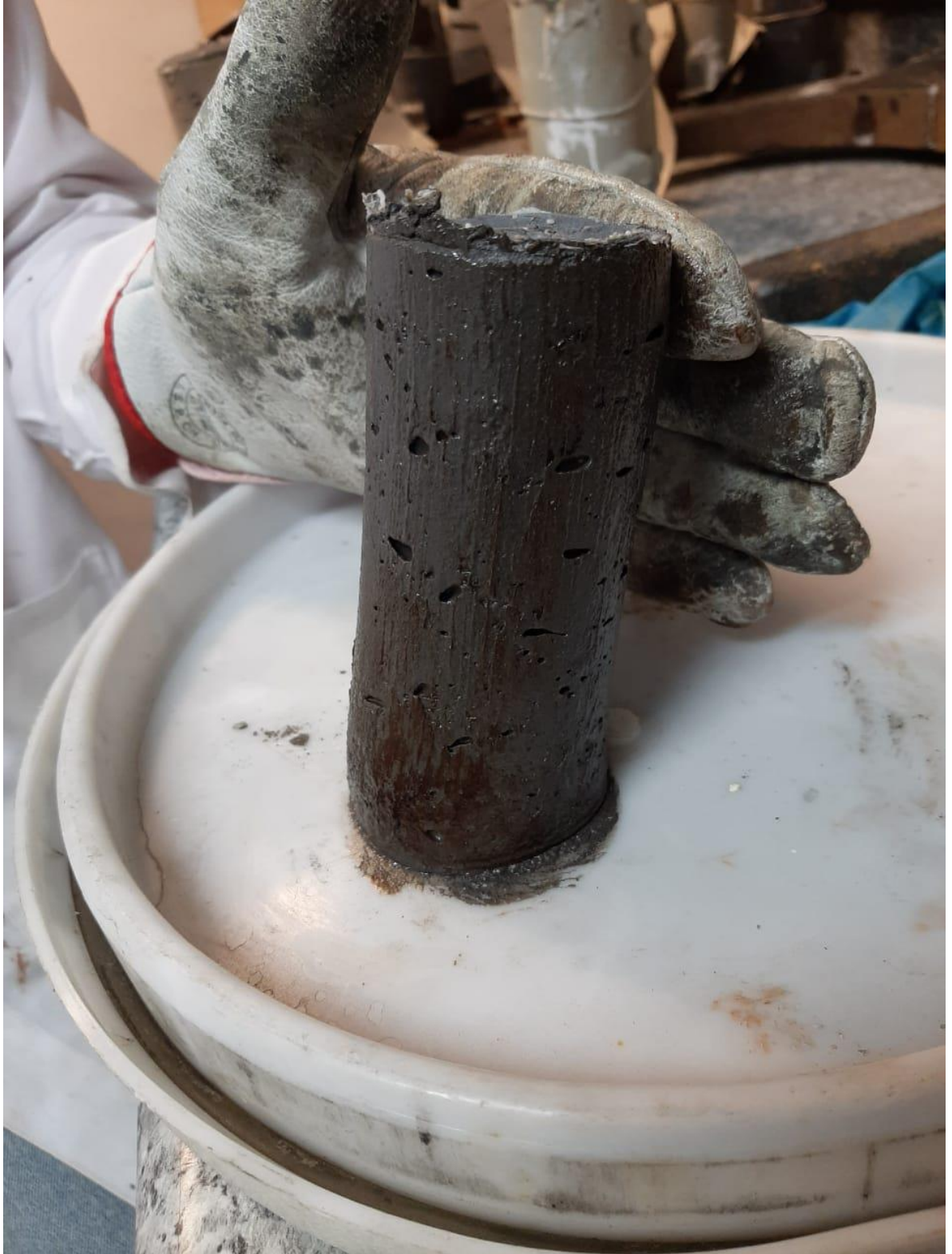
Ilustración 38 Consistencia al instante de la mezcla al desmoldar.
