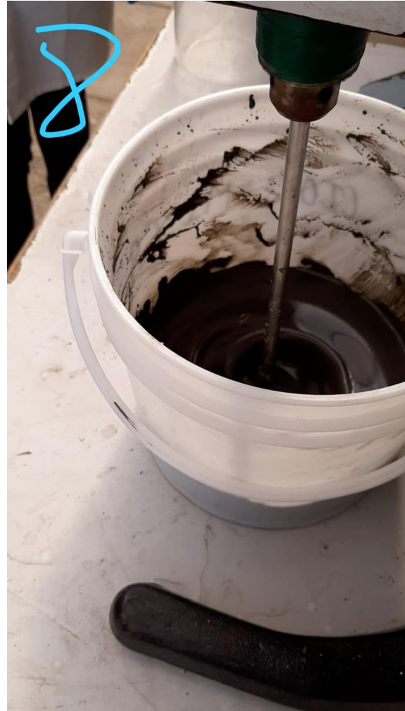
Ilustración 10 Siete minutos de mezclado de los materiales (De este minuto en adelante la consistencia es la misma).
