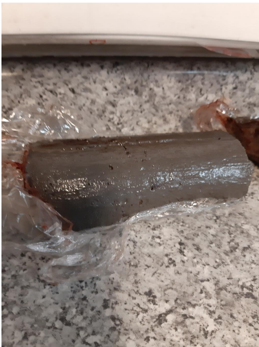
Ilustración 48 Desmolde pasado un minuto método 6 razón A-S 20% 2da réplica
