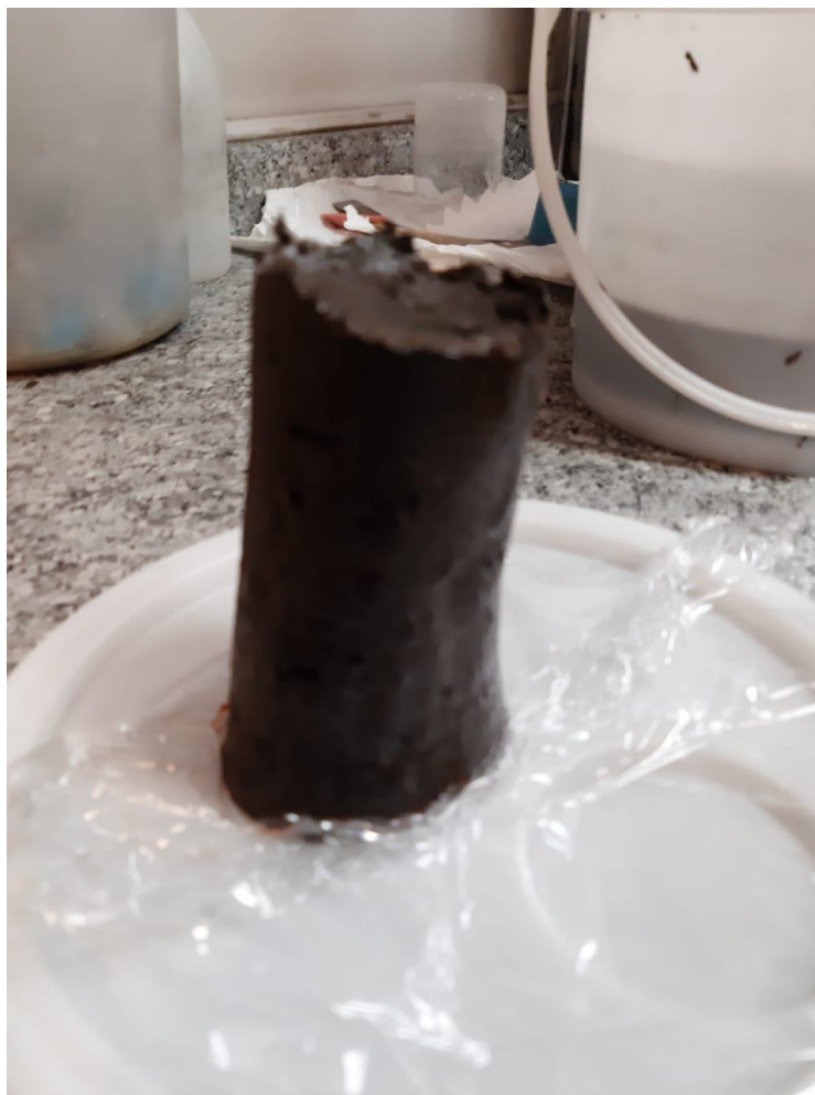
Ilustración 43 Replica 3 desmoldada pasada 1 día
