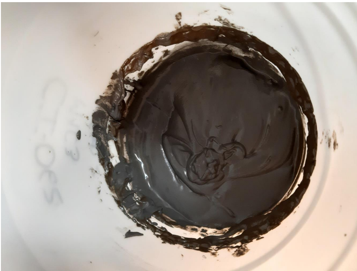
Ilustración 16 Consistencia de la mezcla posterior al “cuchareo” realizada por el método 2 pasada las 24 horas.
