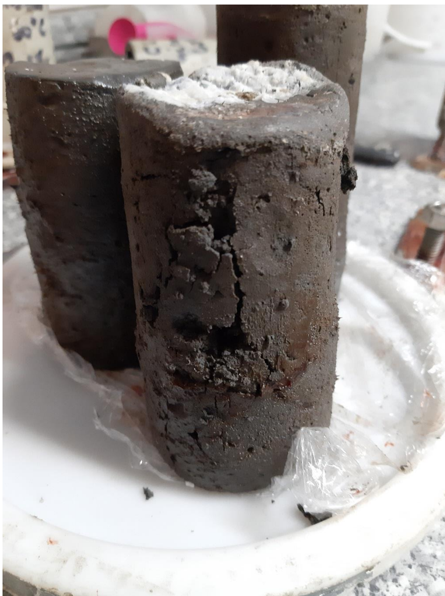
Ilustración 65 Fisura 3ra réplica método 7 post compresión.
