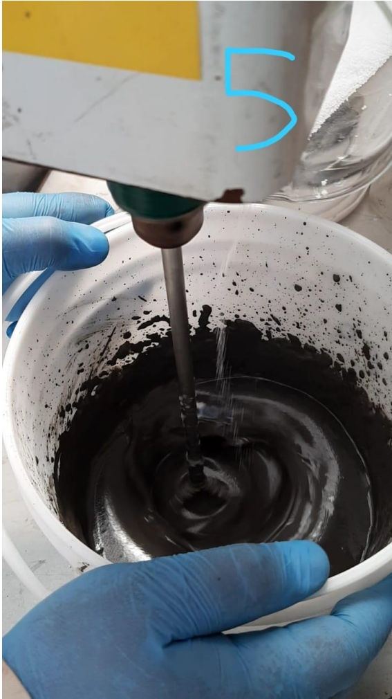
Ilustración 7 Cuatro minutos de mezclado de los materiales.
