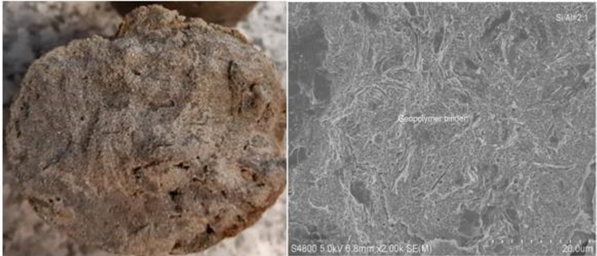
Figura 45 Comparativa muestra método VII (izquierda) vs geopolímero de ratio Si/Al igual a 2 (derecha).
