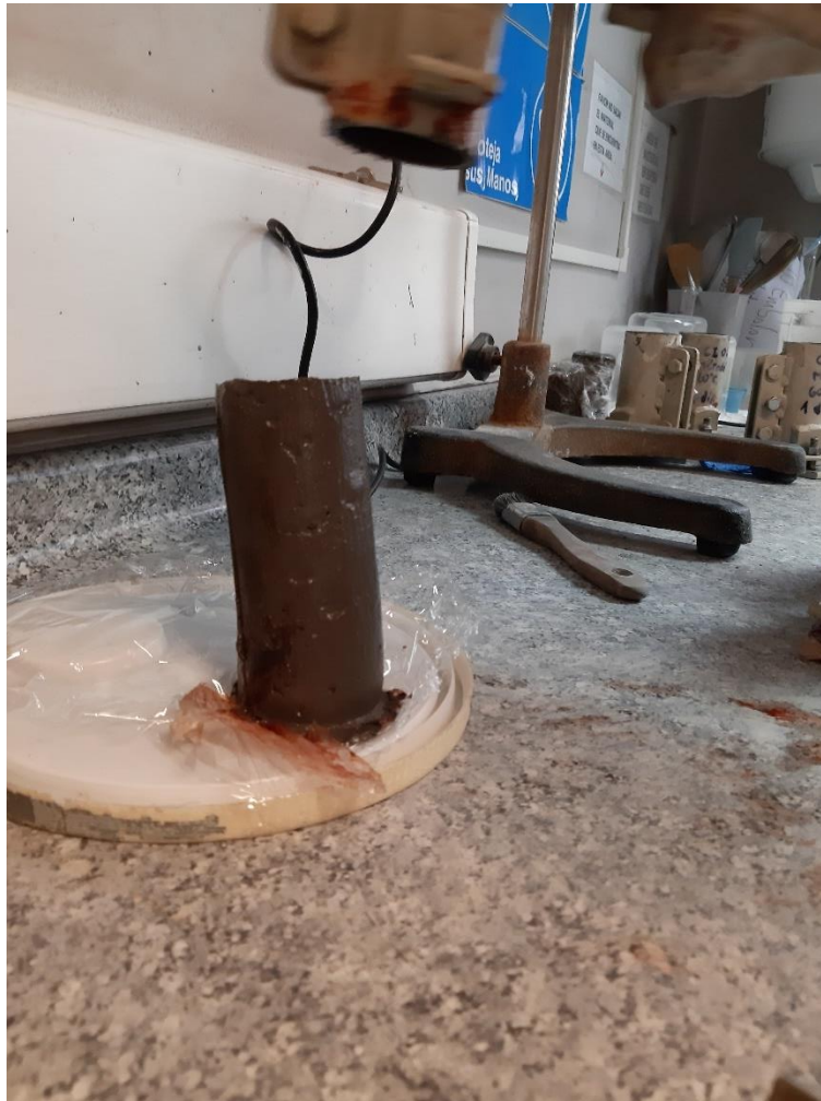
Ilustración 45 Desmolde al instante método 6 razón A-S 20% 1ra replica.
