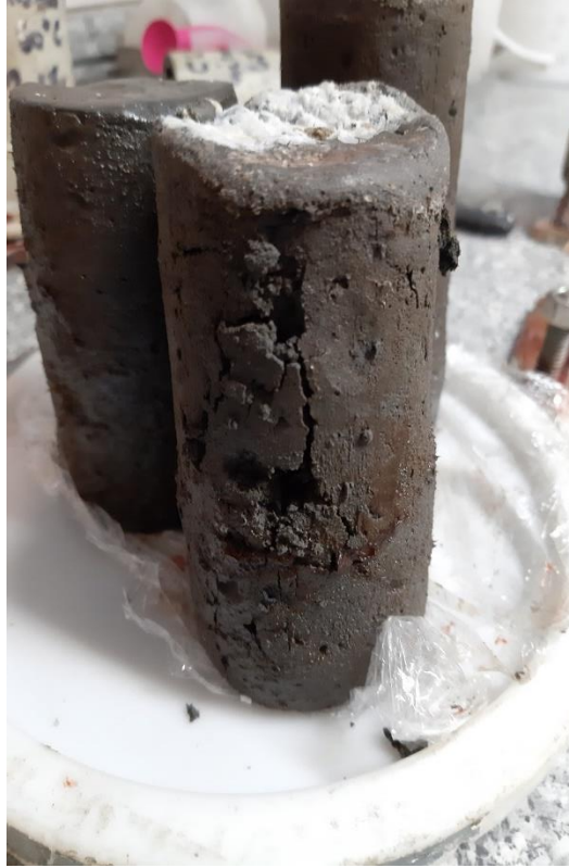
Figura 43 Fisura en probeta de método VII a 60 °C por 7 días.
