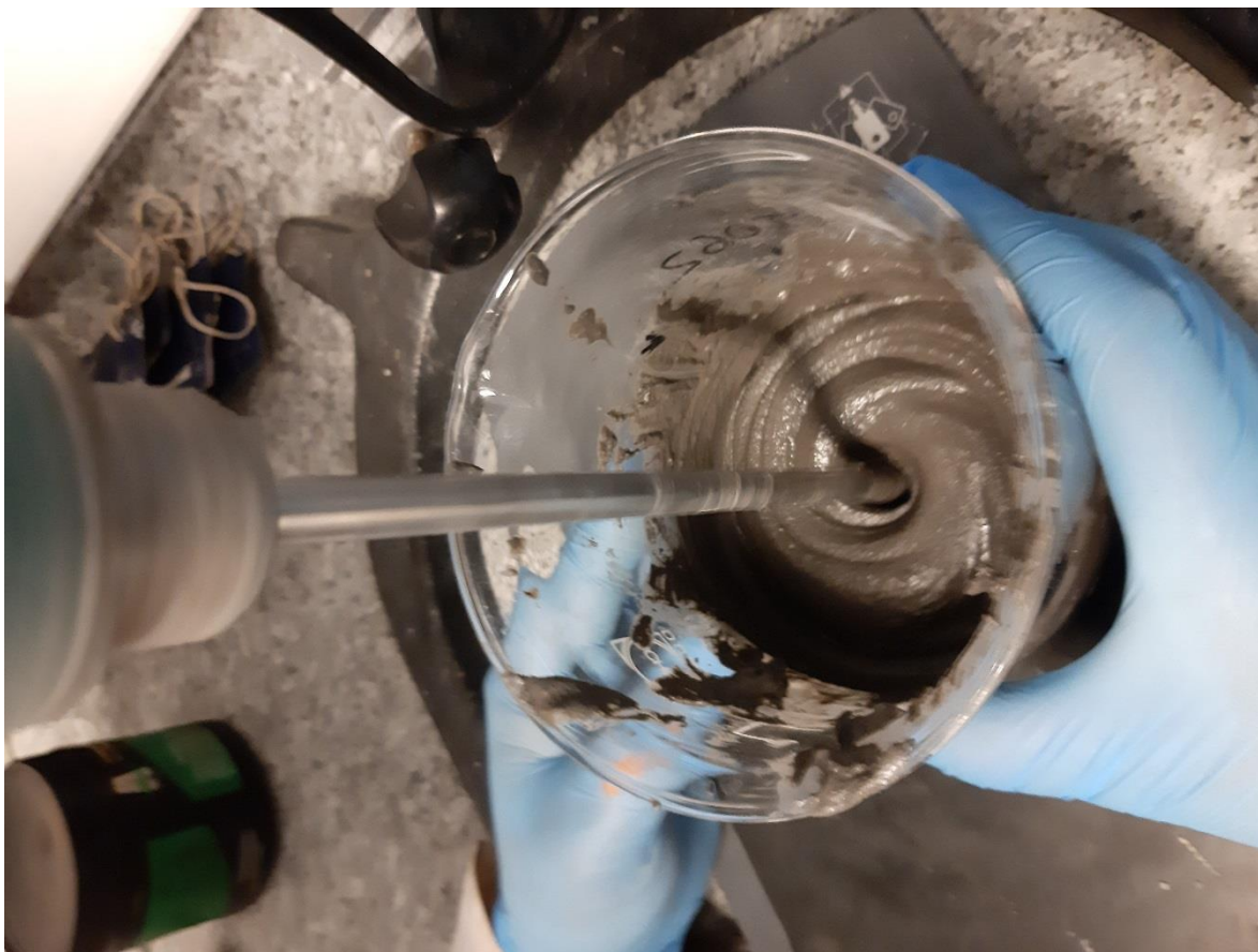
Ilustración 33 Mezcla condición 3 con razón agua/sólidos a 20%.
