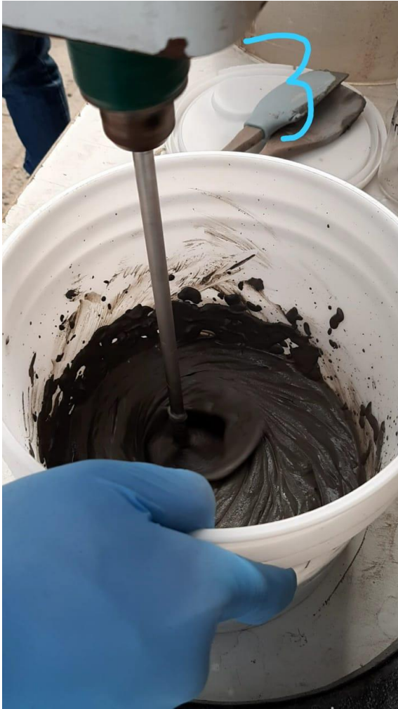
Ilustración 5 Dos minutos de mezclado de los materiales.
