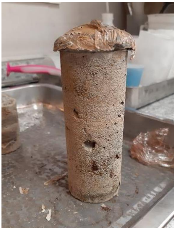
Figura 40 Consistencia método VI con razón agua/sólidos de 20%, 7 días a 90 °C.
