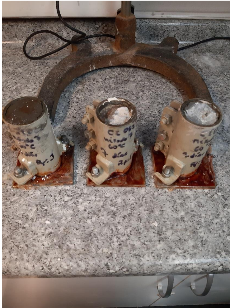
Ilustración 61 Carbonatación sin film método 7 60 °C 7 días.
