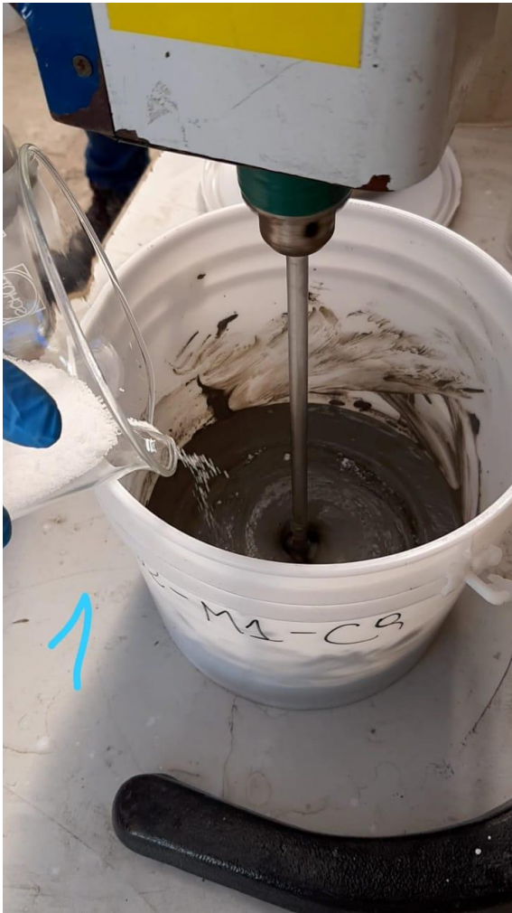
Ilustración 3 Comienzo del mezclado del relave con el agua restante y el hidróxido de sodio.
