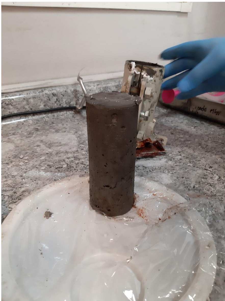
Ilustración 62 Desmolde 1ra réplica método 7 horno 60 °C 7 días.
