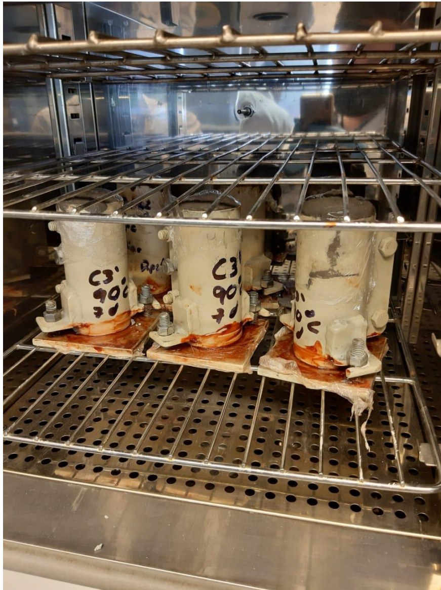
Ilustración 40 Probetas en el horno a 90 °C
