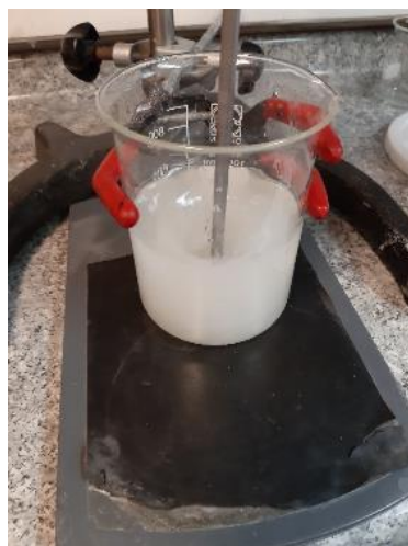
Figura 34 Solución alcalina de hidróxido de sodio de 16 M.
