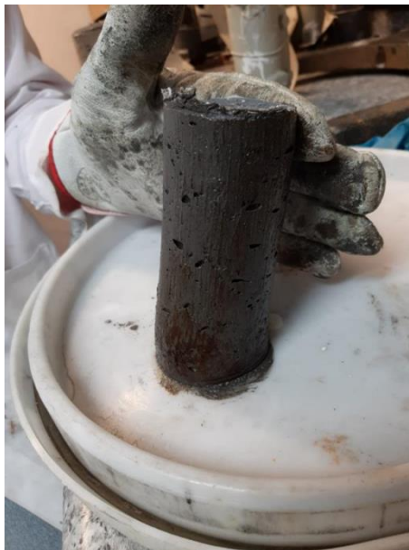
Figura 38 Consistencia método VI con razón agua/sólidos de 20%, 24 horas a 60 °C.
