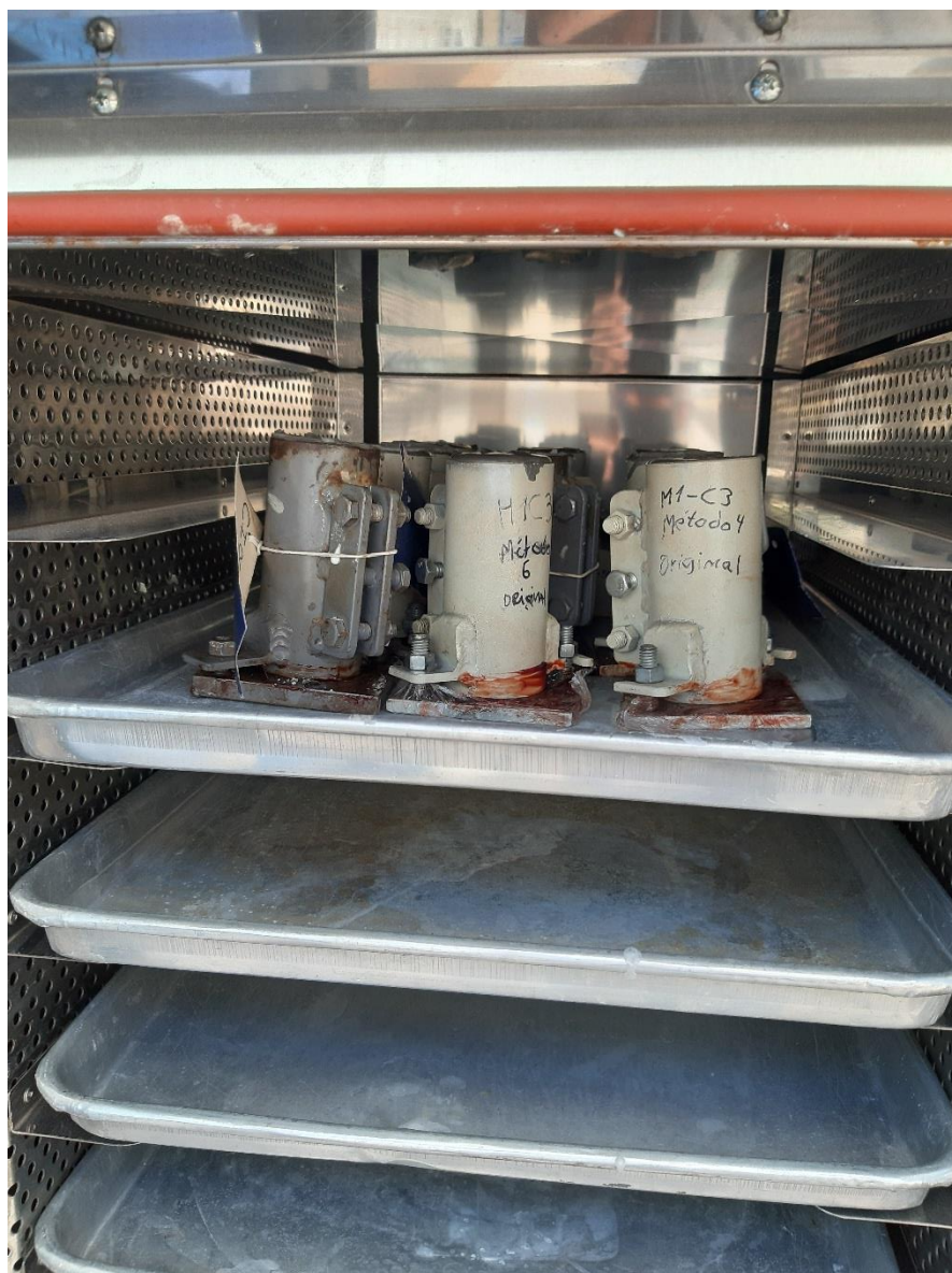
Ilustración 34 Moldes en horno a 60 °C.
