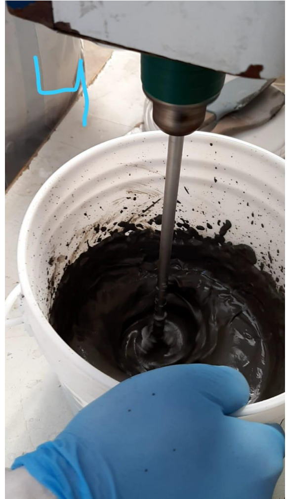
Ilustración 6 Tres minutos de mezclado de los materiales.
