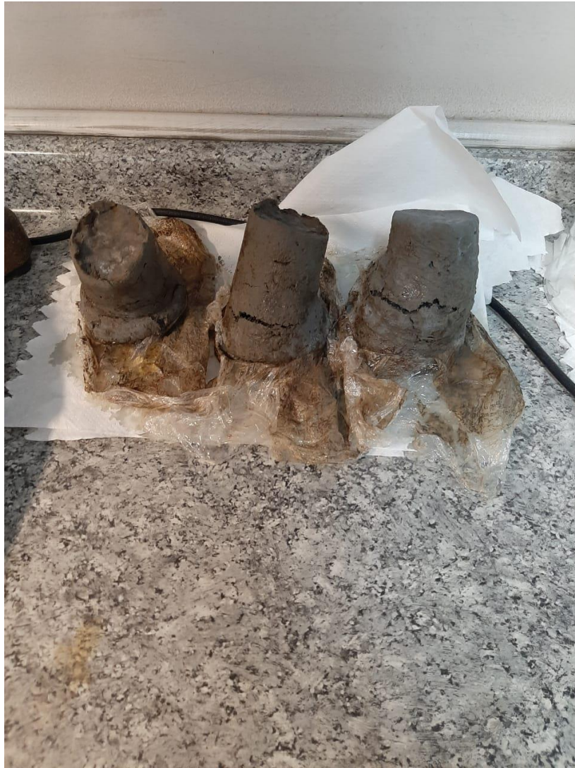
Ilustración 53 Muestras con 1 día en horno a 60 °C y 4 días a temperatura ambiente
