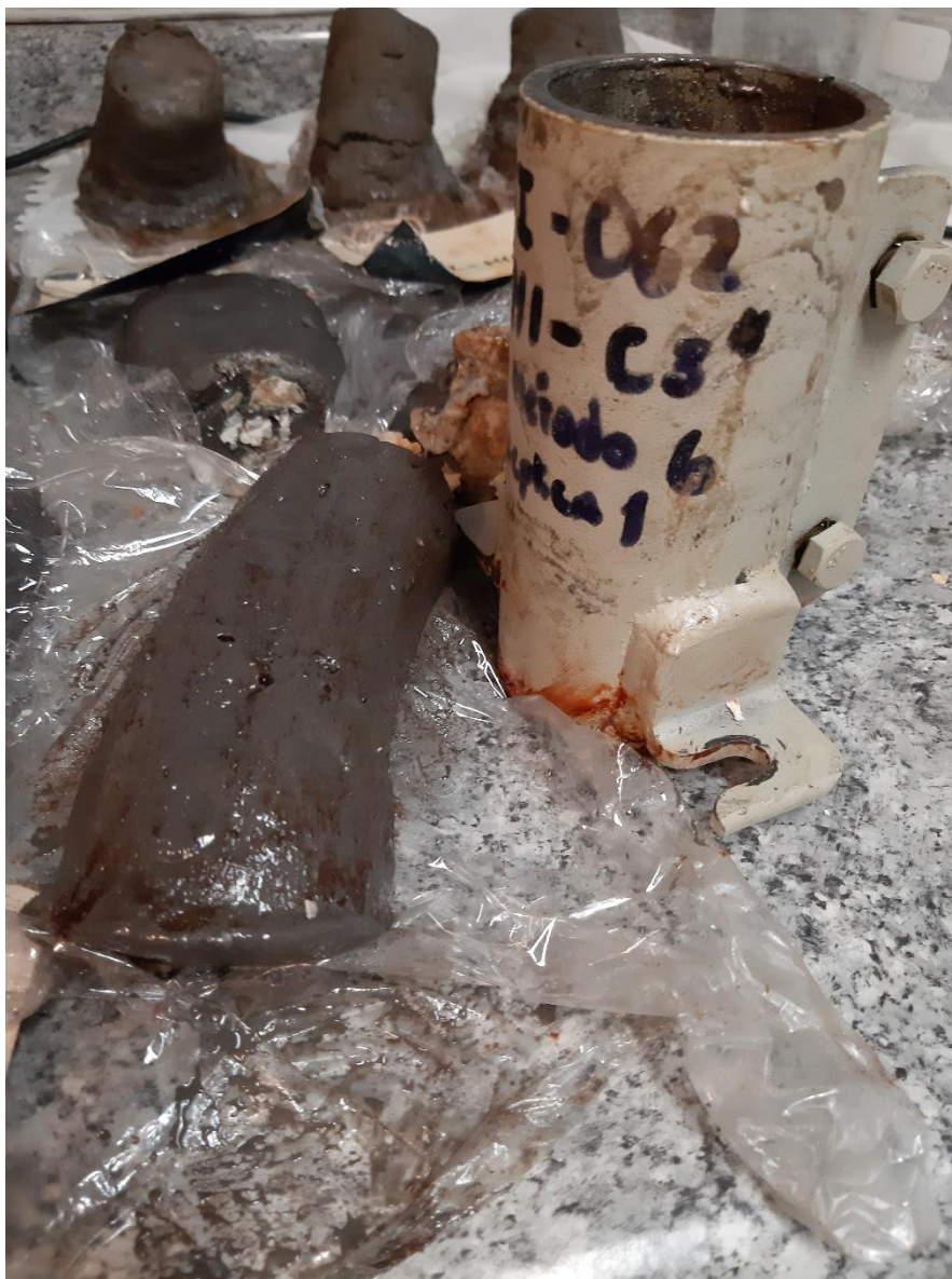
Ilustración 54 Mezcla M1C3' método 6 posterior 7 días a 60°C
