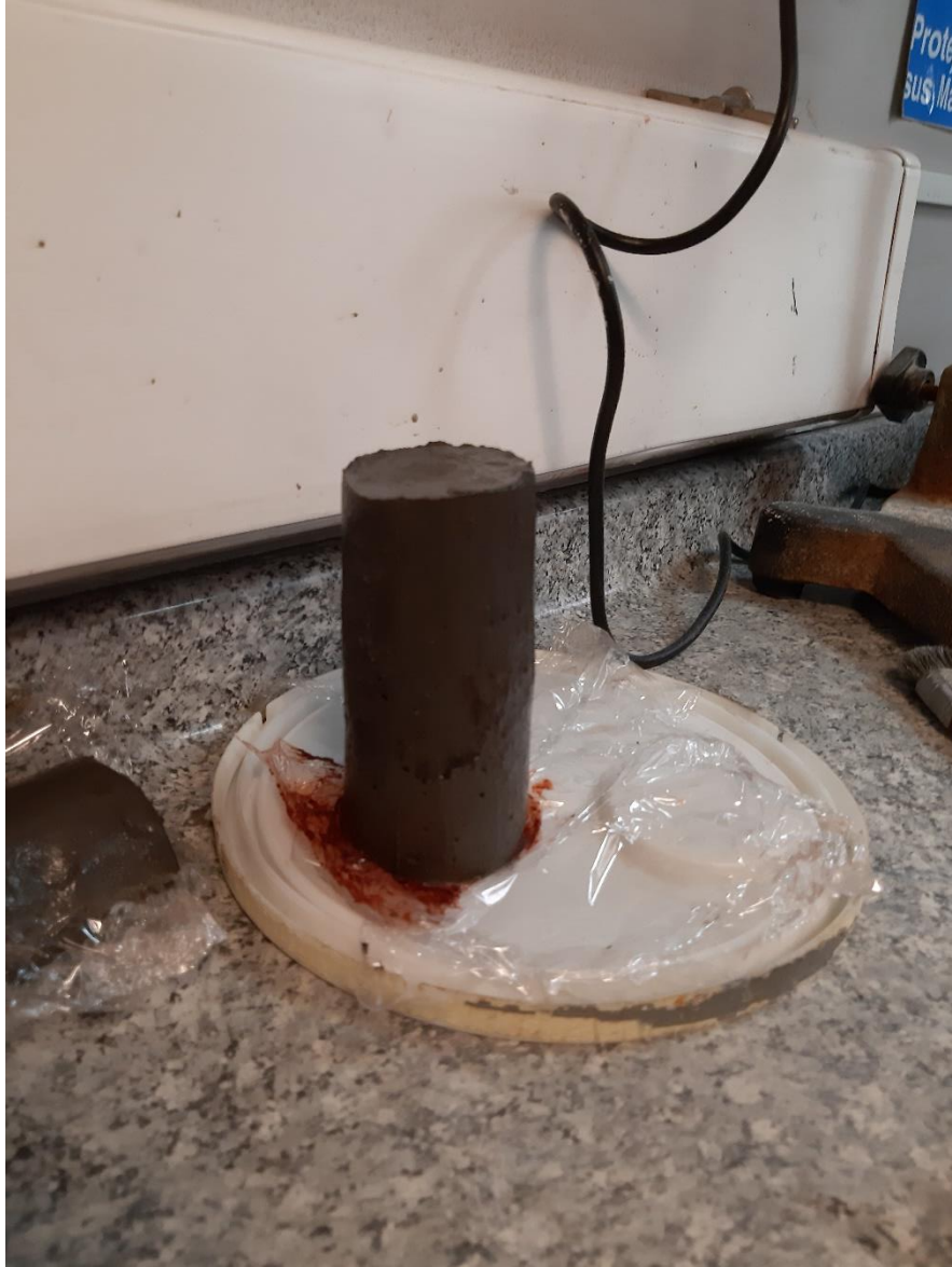
Ilustración 50 Desmolde pasado un minuto método 6 razón A-S 20% 3ra réplica
