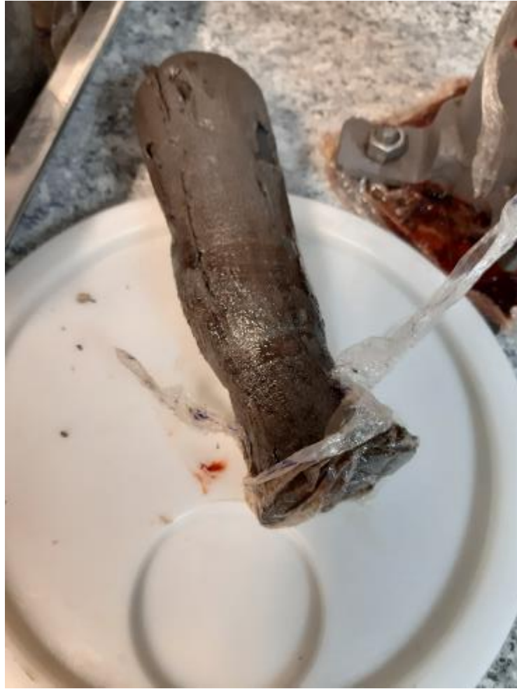
Ilustración 71 1ra réplica método 6 (A-S 20%) de 7 días a 60 °C.
