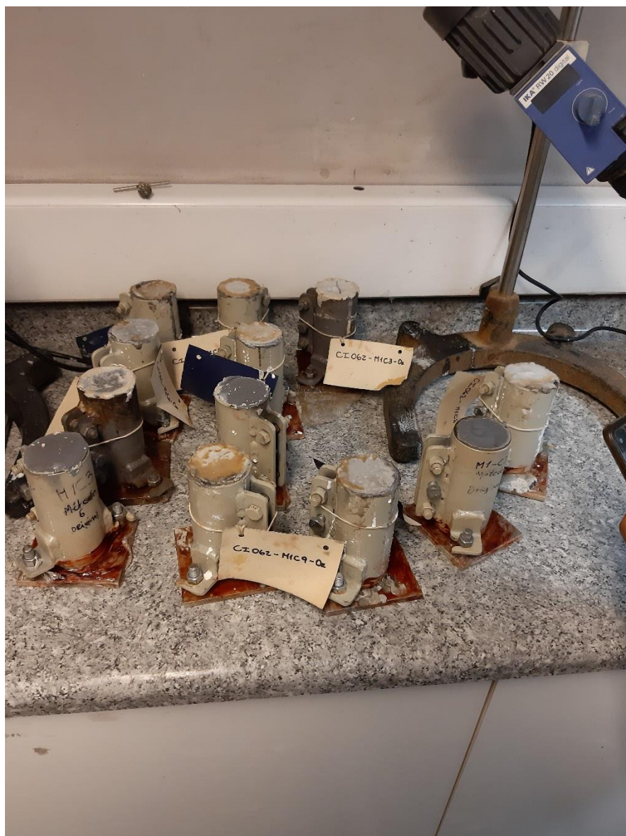
Ilustración 35 Moldes post 24 horas al horno a 60 °C.
