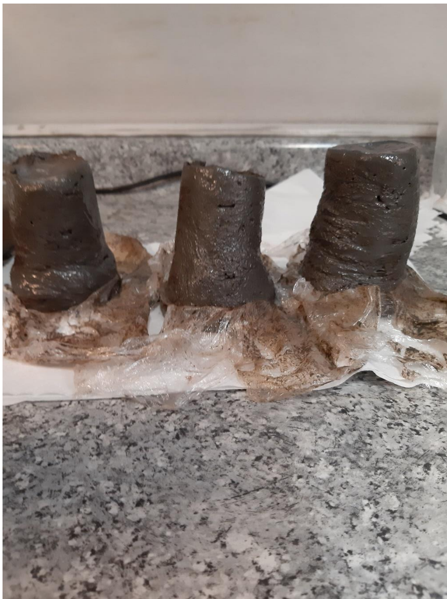
Ilustración 52 Mezclas método 7 desmoldadas post 24 horas a temperatura ambiente
