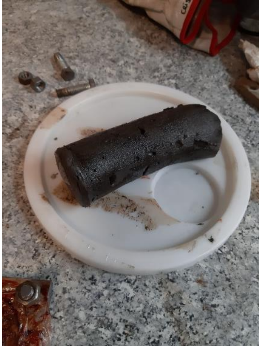
Ilustración 72 3ra réplica método 6 (A-S 20%) de 7 días a 60 °C.
