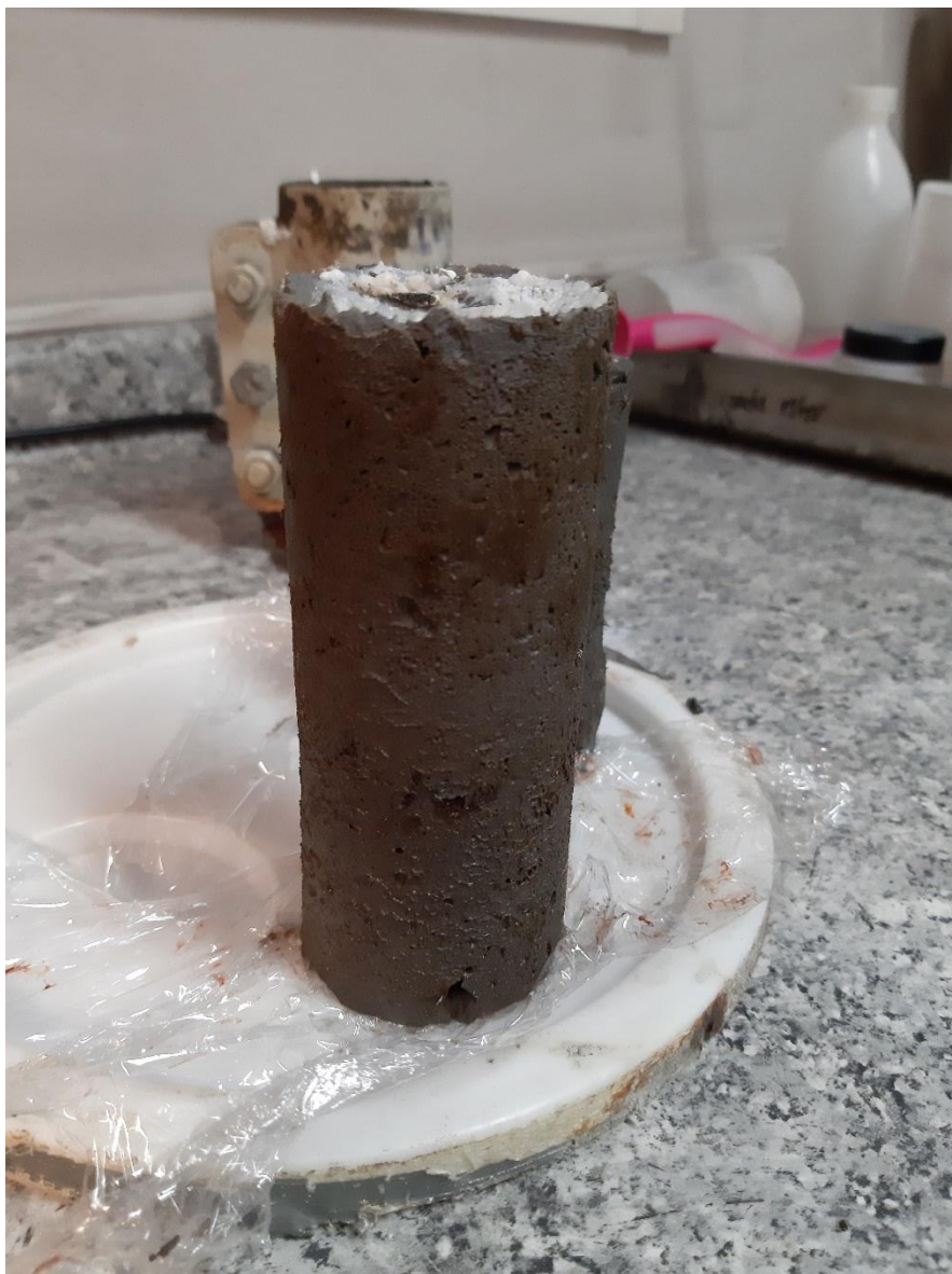
Ilustración 63 Desmolde 2da réplica método 7 horno 60 °C 7 días.
