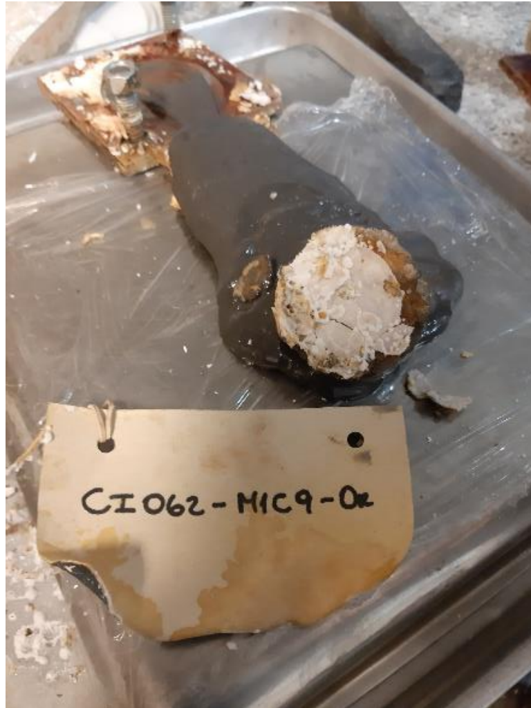
Figura 30 Carbonatación mezcla método I posterior a 7 días en horno a 60 °C
