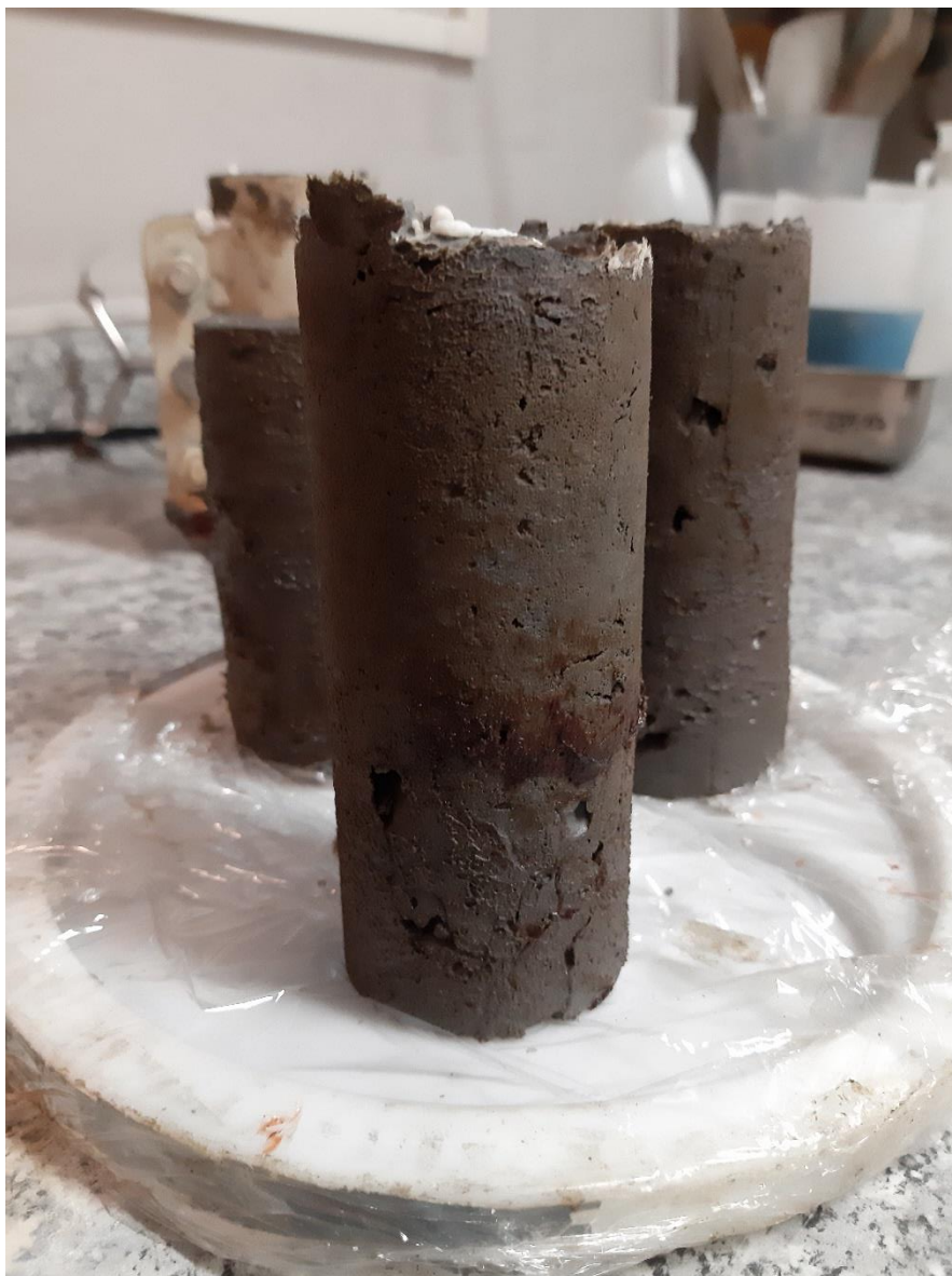
Ilustración 64 Desmolde 3ra réplica método 7 horno 60 °C 7 días.
