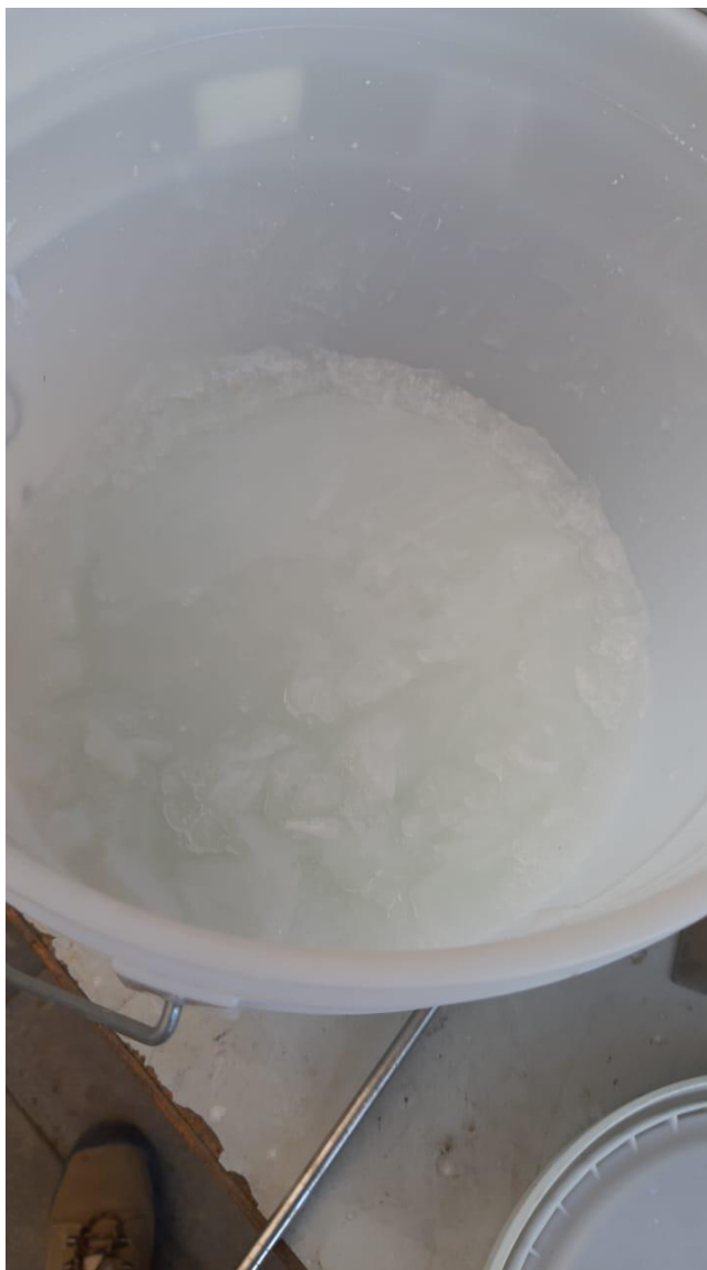
Ilustración 2: Solución de hidróxido de sodio completamente cristalizada.
