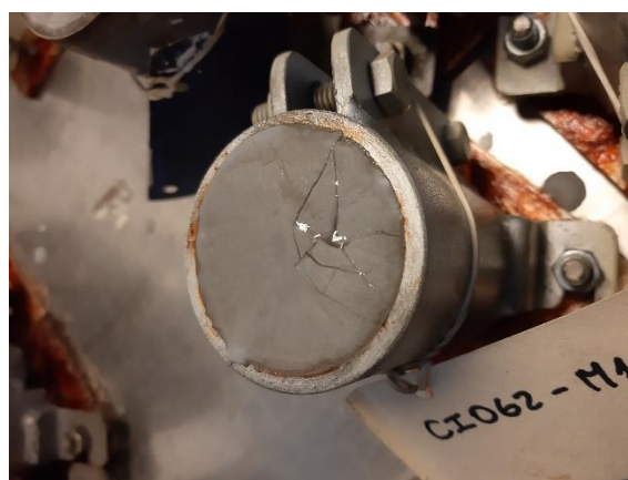
Ilustración 12 Condición de probeta posterior a las 24 horas de endurecimiento.
