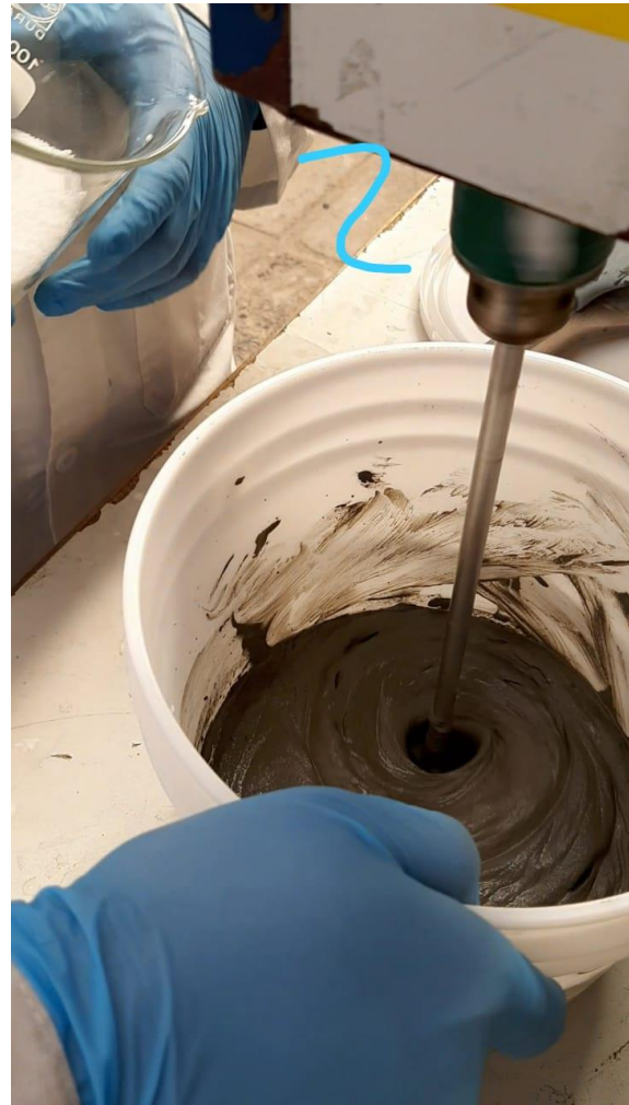
Ilustración 4 Un minuto de mezclado de los materiales.
