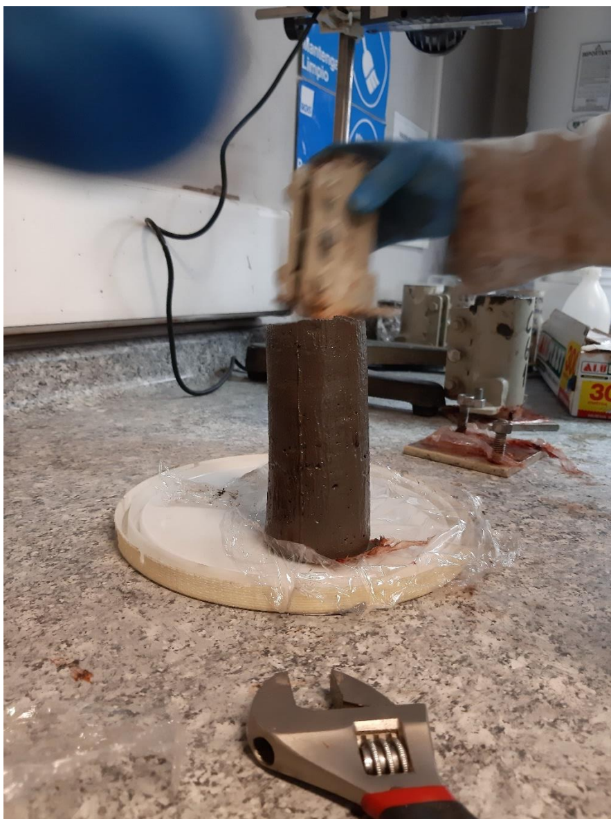
Ilustración 47 Desmolde al instante método 6 razón A-S 20% 2da replica
