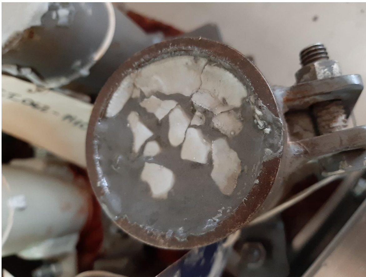
Ilustración 13 Condición de probeta pasada las 48 horas de endurecimiento.
