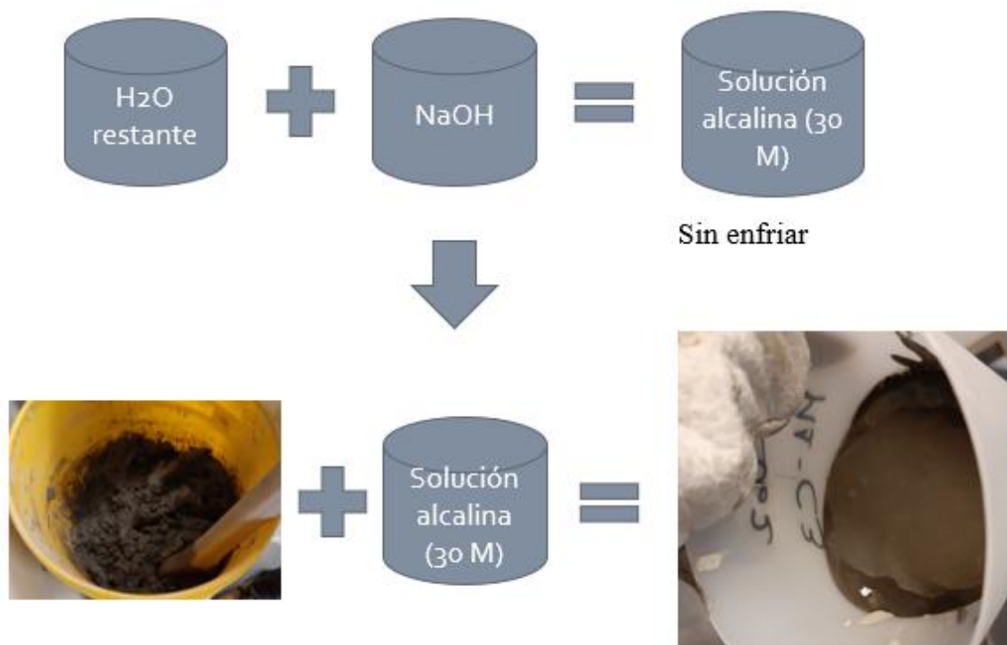
Figura 25 Esquema método IV
