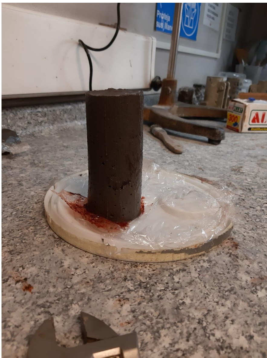
Ilustración 49 Desmolde al instante método 6 razón A-S 20% 3ra replica
