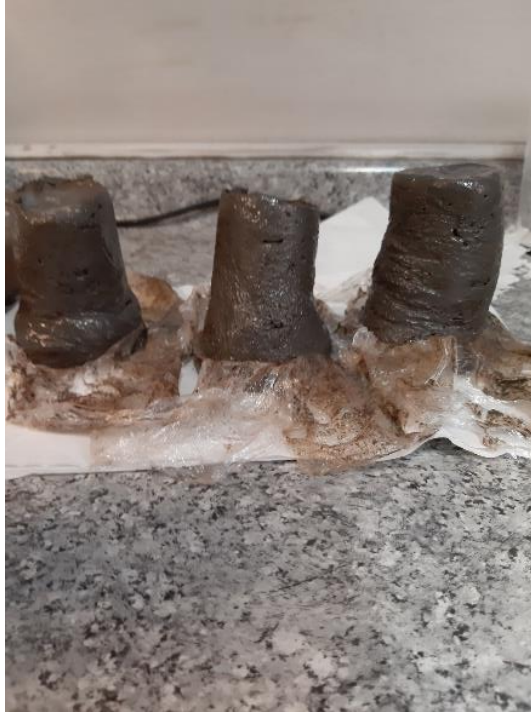
Figura 41 Mezclas método VII (1 día a 60 °C) post 24 horas a temperatura ambiente.
