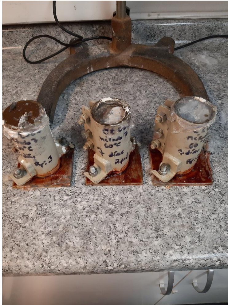
Ilustración 60 Carbonatación con film método 7 60 °C 7 días.
