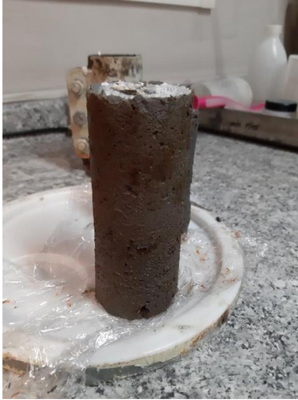
Figura 42 Método VII, horno a 60 °C por 7 días.
