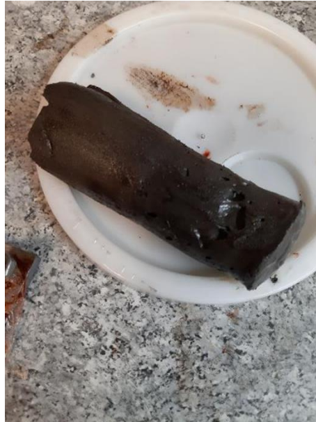
Figura 39 Consistencia método VI con razón agua/sólidos de 20%, 7 días a 60 °C.
