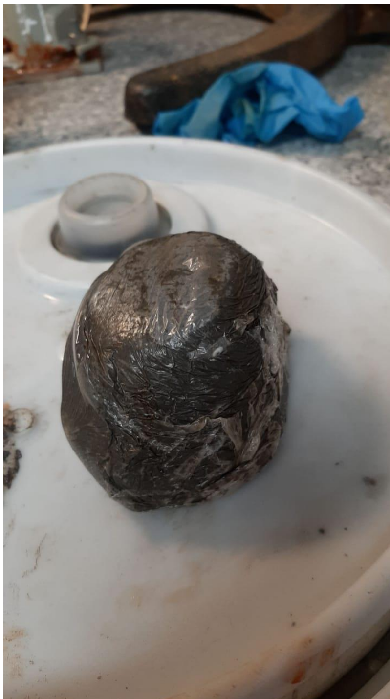
Ilustración 39 Consistencia de la mezcla pasado unos minutos del desmolde.
