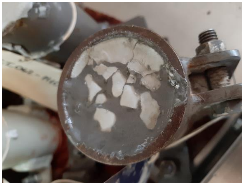
Figura 29 Condición de la mezcla realizada con el método I posterior a las 24 horas a temperatura ambiente.
