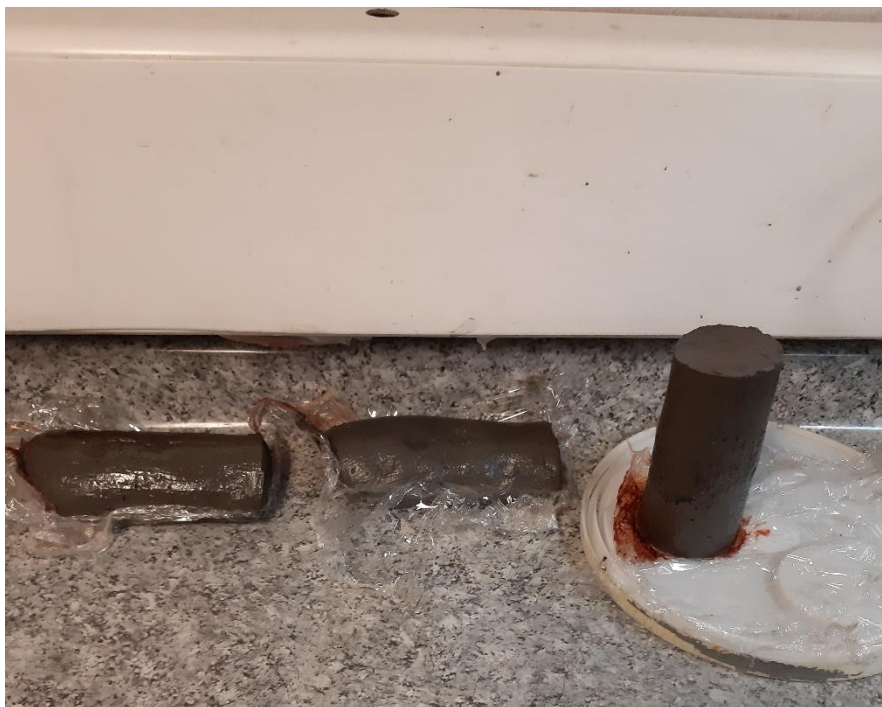
Ilustración 51 Mezclas método 6 A-S 20% desmoldadas post 1 día a 60 °C
