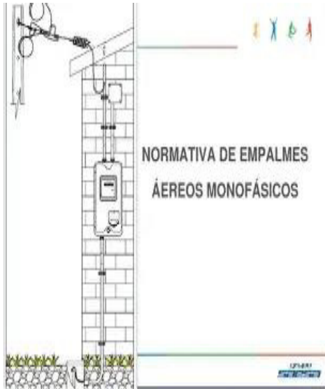
Figura 7: Empalme aéreo monofásico.
