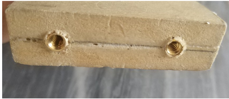
(b) Insertos instalados en soporte horizontal (14)
