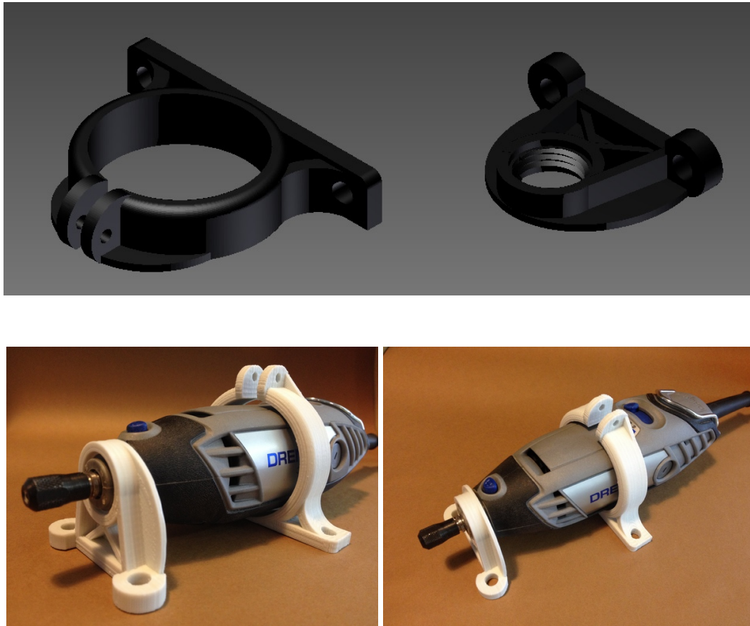
Figura 3.8: Dremel 3000 con el adaptador para montarlo en la máquina.
