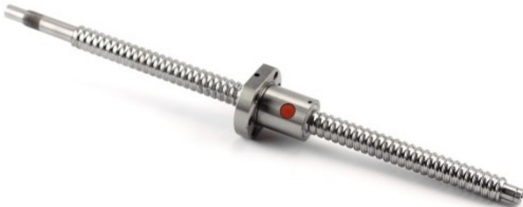
Figura 3.2: Ballscrew de diámetro 16 mm, 5 mm de paso y 400 mm de largo.
