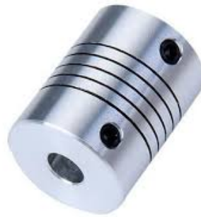
Figura 3.3: Acople flexible, para ejes de 6 mm y 10 mm, como los usados en motores NEMA23 y los husillos de bolas 1605 respectivamente.
