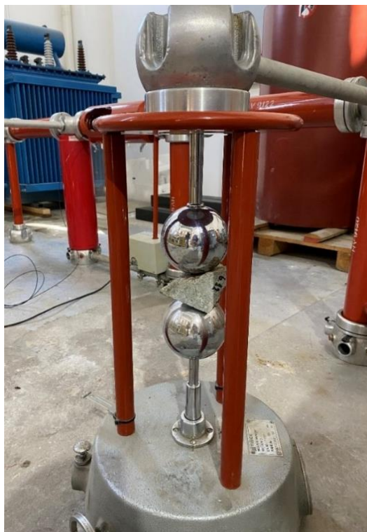
Figura 3.9 Generador de impulsos eléctricos utilizado durante este estudio. Entre los electrodos esféricos se encuentra la muestra 6.9.
