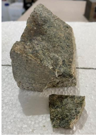
Figura 4.11 Fractura superficial provocada por la aplicación de impulsos eléctricos sobre la muestra 8.4.
