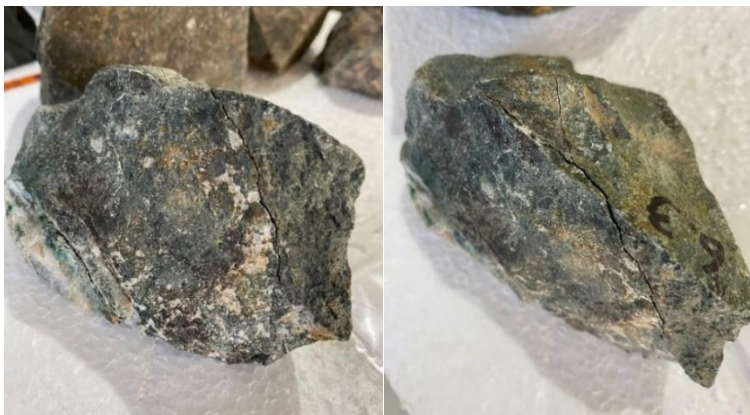
Figura 4.9 Fracturas provocadas por la aplicación de impulsos eléctricos en la muestra 6.3.
