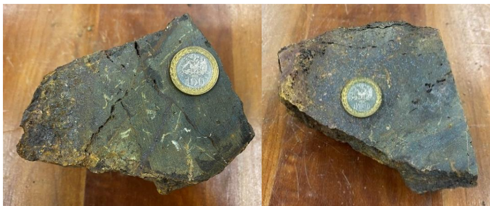
Figura 4.8 Discontinuidades presentes en las muestras 3.1 y 3.2, respectivamente.
