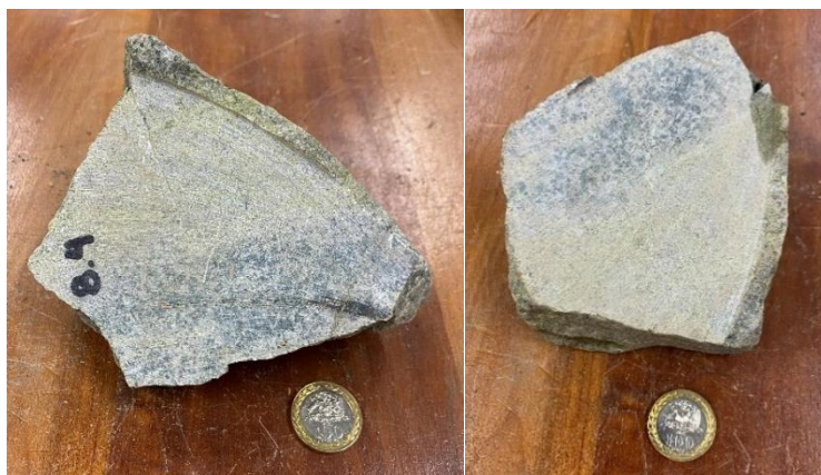
Figura 4.10 Contacto litológico presente en las muestras 8.4 y 8.8, respectivamente.
