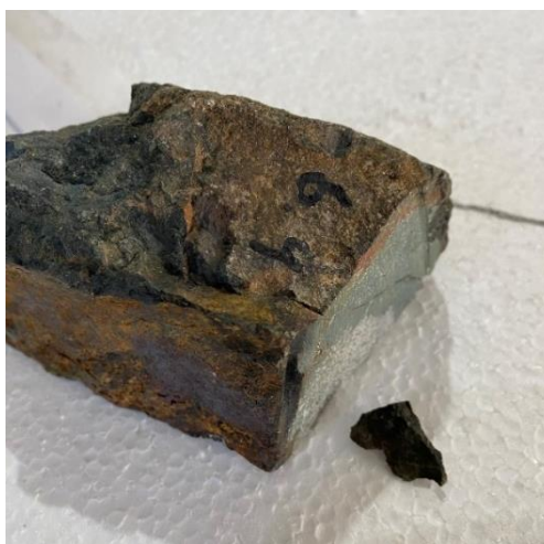
Figura 4.17 Fractura superficial provocada por la aplicación de impulsos eléctricos sobre la muestra 6.4.
