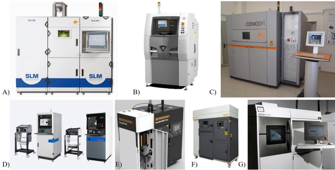
Figura 7-4: Se presentan las impresoras aditivas SLM reportadas en los resultados. A) SLM 250 HL (Fuente: SLM Solutions GmbH). B) 3D System ProX - 200 Equipment (Fuente: 3D Systems). C) M3 Linear Machine (Fuente: Concept Laser). D) mLab (Fuente: General Electric Additive). E) RenAM 500M LPBF System (Fuente: Renishaw PLC). F) Renishaw AM250 (Fuente: Renishaw PLC). G) EOS M270 DMLS (Fuente: EOS Group).
