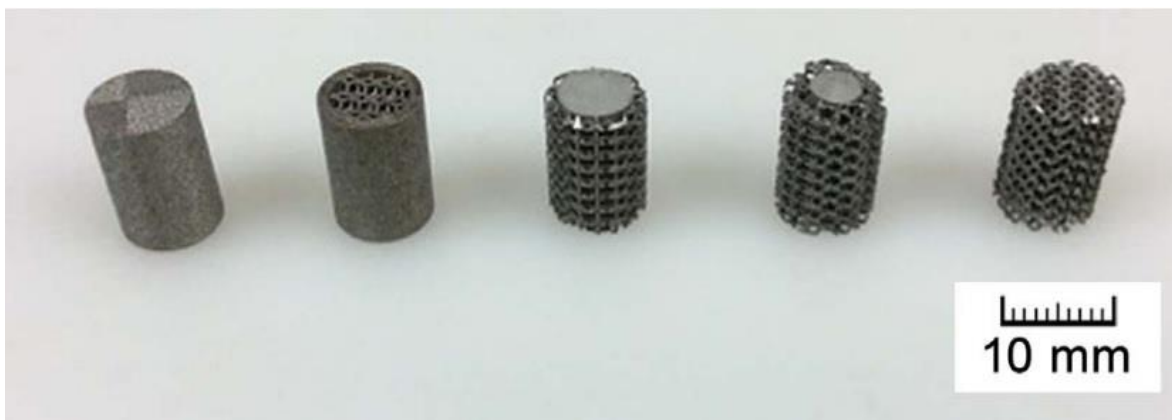
Figura 5-2: Especímenes desarrollados para ensayo de compresión: Completamente sólido, con superficie sólida, con superficie porosa (1 y 2[mm]) y completamente poroso [53].
