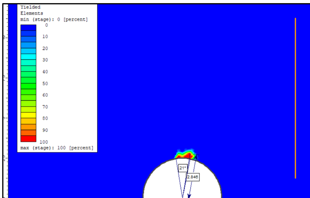
Figura 97: Medición de la profundidad y extensión de falla para l=10 [m], \theta=90[^\circ] y d=5 [m].
