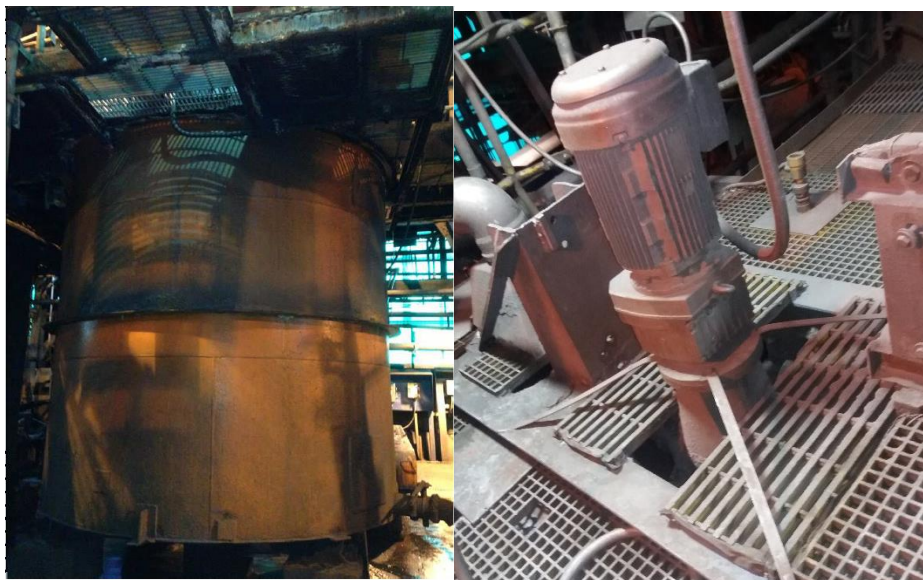
Figura 24 Estanque y motorreductor de lixiviación.
