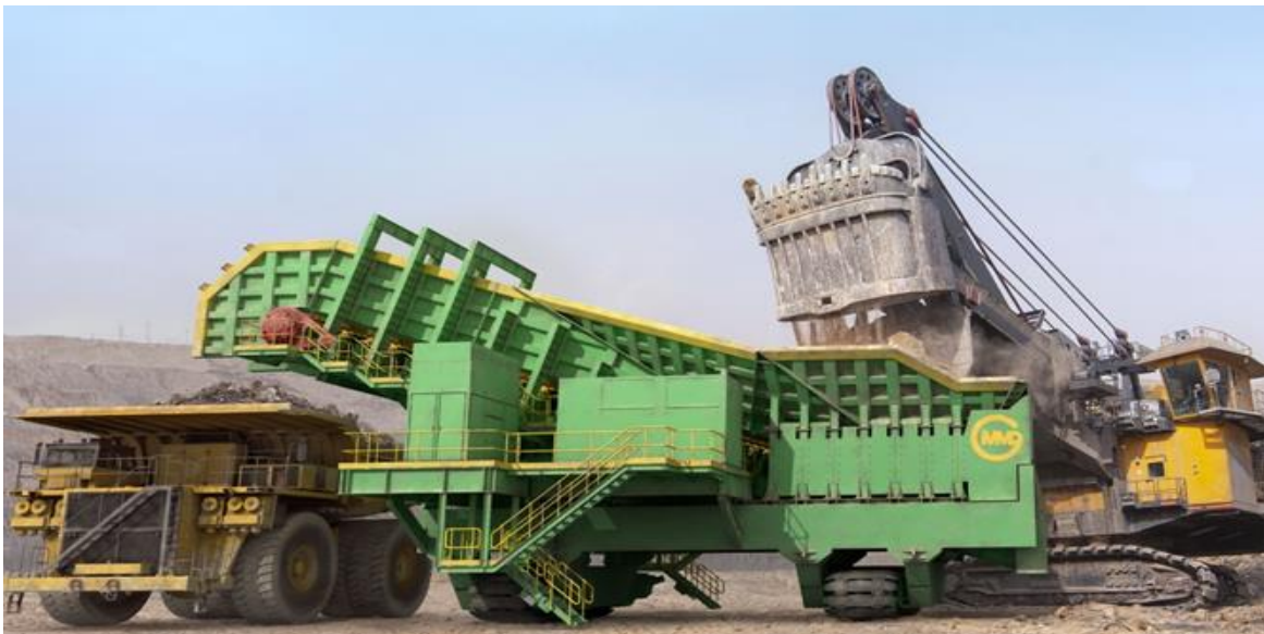
Figura 2.1: Tolva móvil entre la pala y el camión, puesta en marcha en una operación minera.
