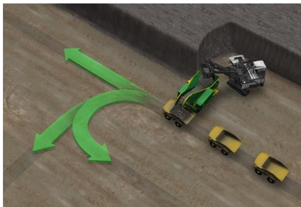
Figura 2.3: Eliminación del tiempo de acuatamiento, dada la forma en que opera este equipo.
