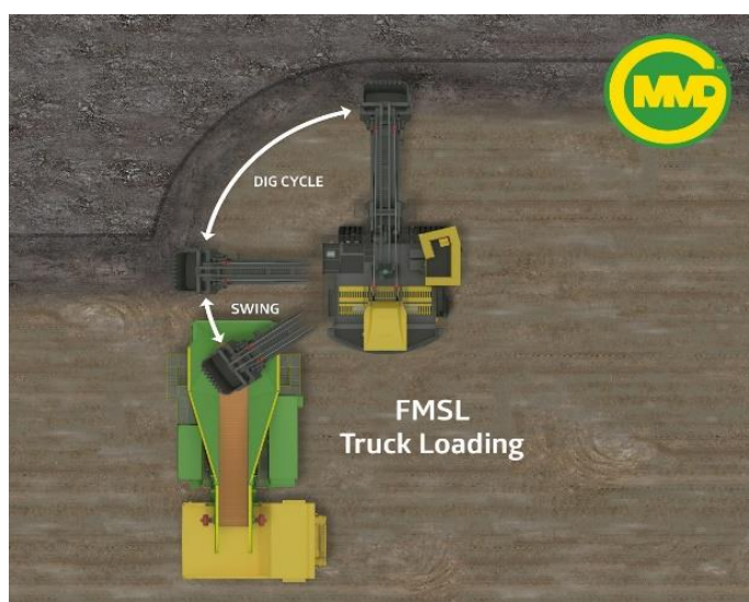
Figura 2.5: Escenario de carguío usando la Tolva Móvil.
