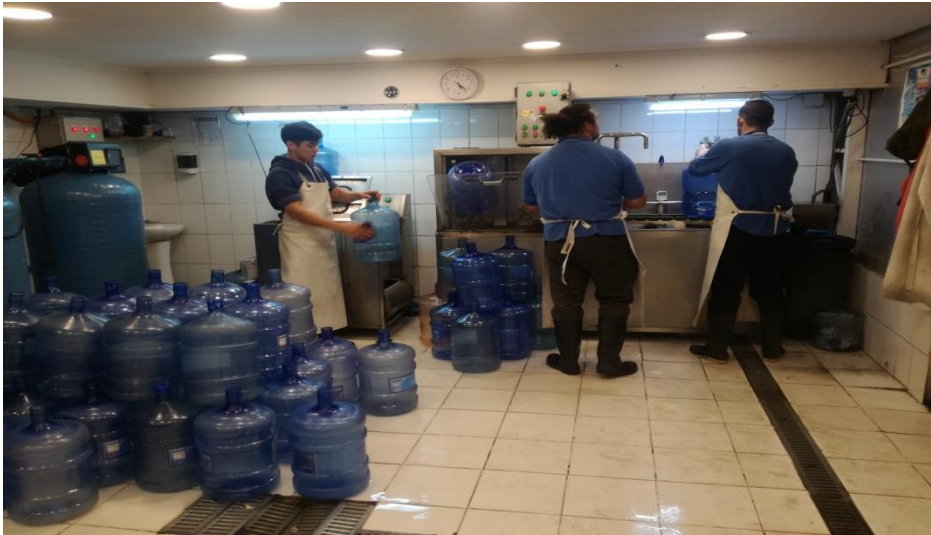
Figura 1-5: Fotografía donde se observa al trabajador en el lado izquierdo repasando un botellón manualmente, luego él los introduce en la maquina enjuagadora. (Empresa Agua Katty, 2019)
