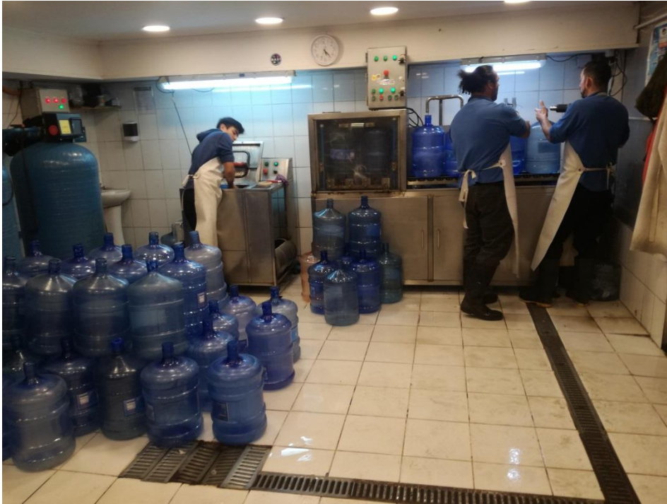
Figura 1-6: Fotografía donde se aprecia como el trabajador ubicado al costado derecho de la imagen está sellando el botellón ya llenado, con una pistola de calor. (Empresa Agua Katty, 2019)
