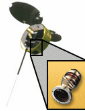
Figura 2.9: Optical Transient Detector con MicroLab1. Extraído de [35]
