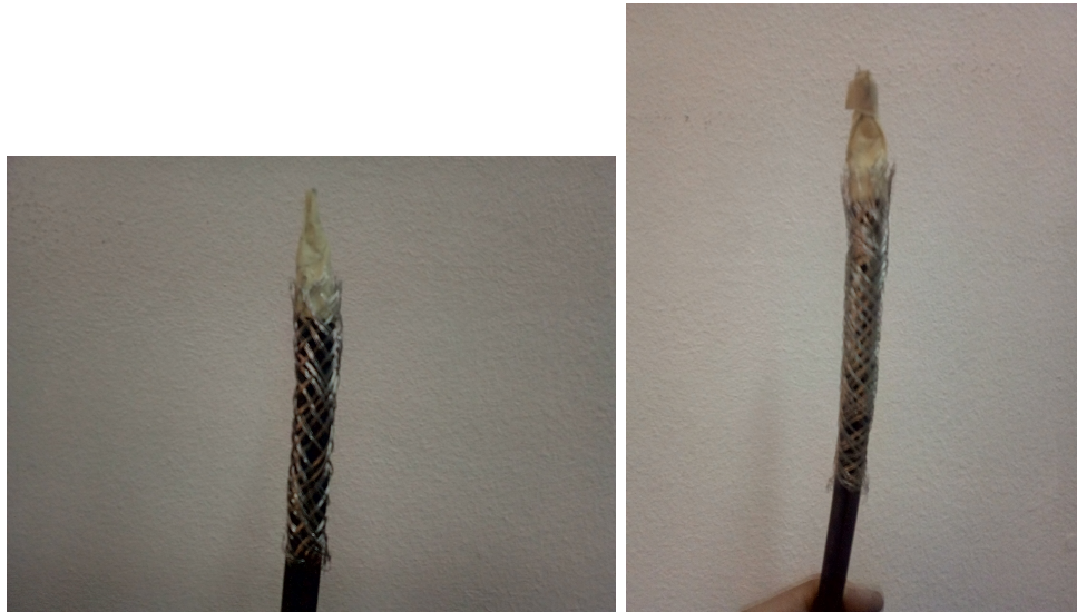
Figura 4.6: Enmallado de aluminio para protección mecánica
