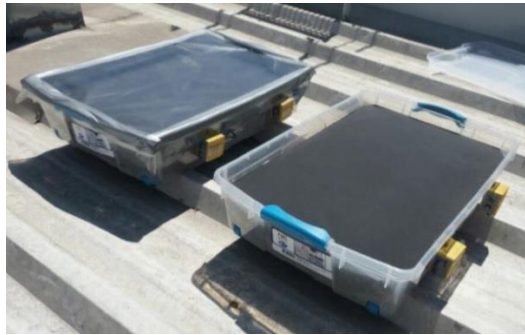
Figura 4 Placa plana utilizada para obtener la temperatura de placa y realizar el cálculo de potencia de enfriamiento (Barrios, 2018).
