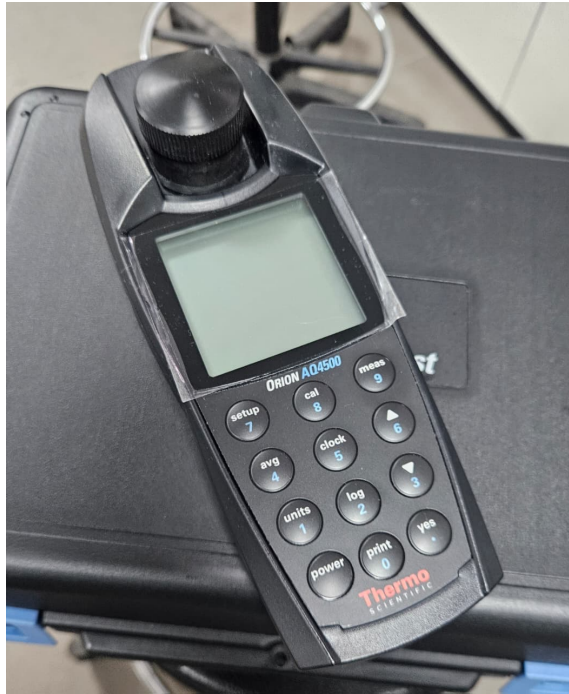
Figura 3.4: Equipo Thermo Scientific Orion AQUAfast AQ4500 [Elaboración propia].
