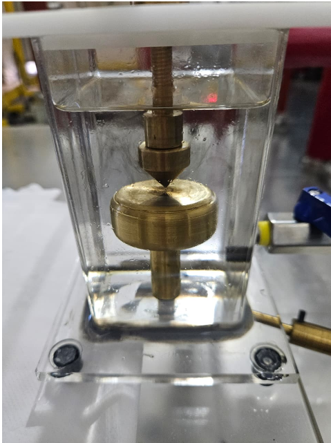
((a)) Vista general de la celda de ensayo con el sistema de electrodos inmerso en aceite.
