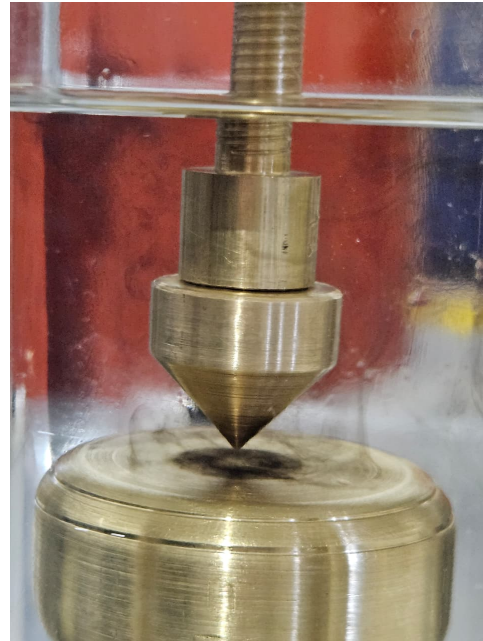
((b)) Acercamiento de la celda de ensayo con el sistema de electrodos inmerso en aceite.
