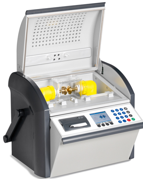
Figura 3.6: Equipo BAUR DPA 75 C utilizado en los ensayos de tensión de ruptura. [44]
