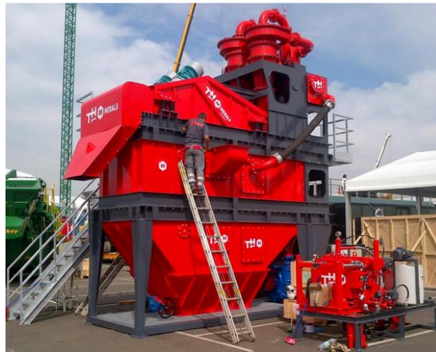
Figura 5.10: Planta de hidrociclonado.
